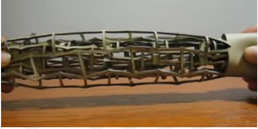
Şekil 2.25 : Rulo yapının çekme kuvveti altında şekil değişimi.
