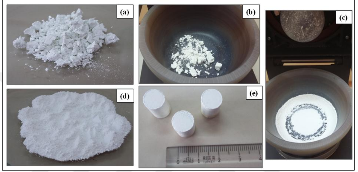
Şekil 3.4: 1250 °C'de ısıtılma işlemi gören HA çökeltilerini havan öğütücüsünde öğütme işlemi (a-d) ve elde edilen tozlardan hazırlanan silindirik peletler (e).
