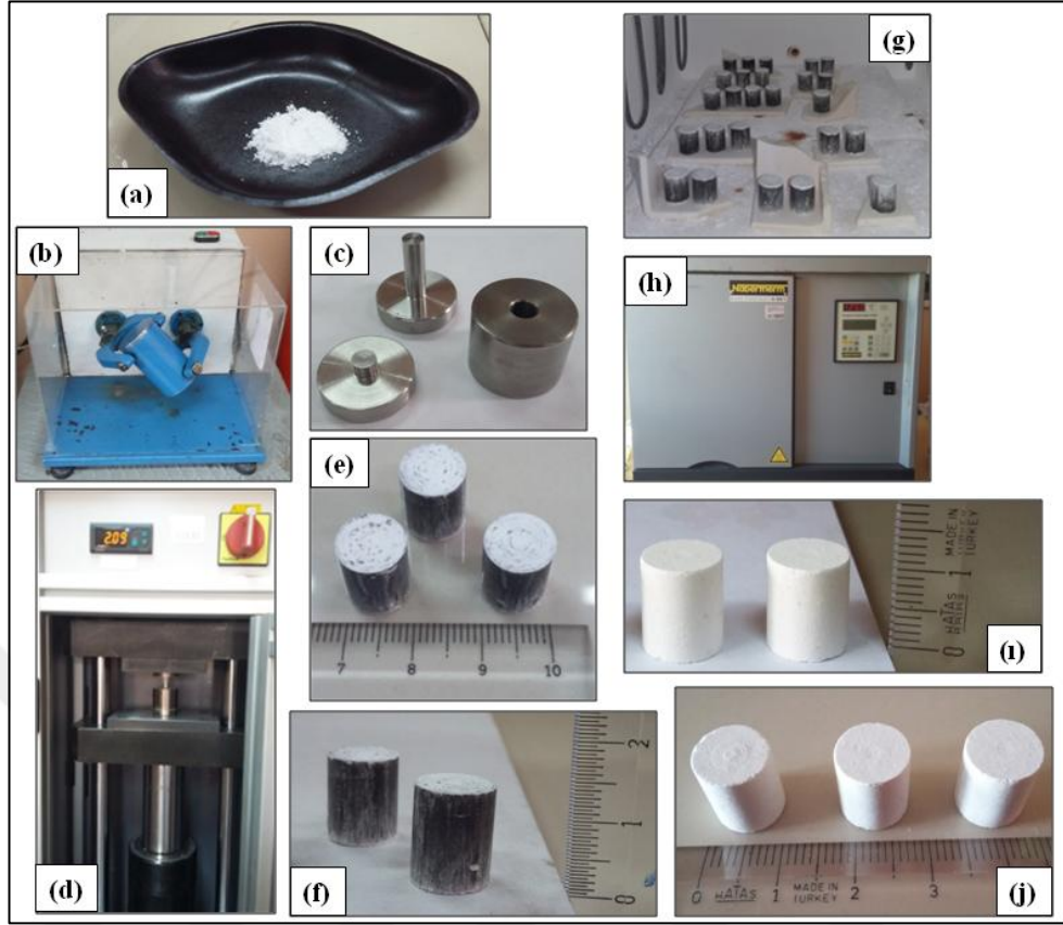
Şekil 3.8: Üçlü kompozit peletlerinin oluşturulması sürecinde takip edilen adımlar; (a-b) kompozit tozu bileşenlerinin ayrı ayrı tartılması ve karıştırılması, (c-d) kompozit tozlarının şekillendirilmesinde kullanılan paslanmaz çelik kalıplar ve tek eksenli el presi, (e-f) preslenmiş ham peletlerin ölçekli görüntüleri, (g-h) peletlerin 1250 °C’de sinterlenmesi için kullanılan yüksek sıcaklık laboratuvar fırını ve peletlerin fırın içi yerleşim düzenine ait bir görüntü, (ı-j) sinterleme sonrası peletlerin ölçekli görüntüleri.
