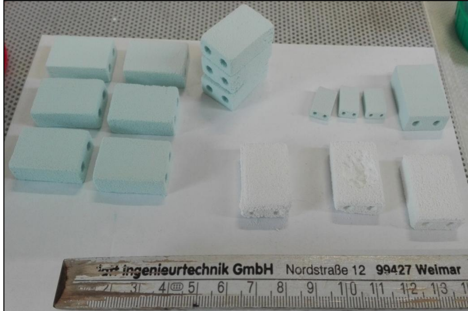
Şekil 4.66: HA950 tozları kullanılarak 3b yazıcıdan baskısı alınan parçalar (beyaz renkte olanlar).
