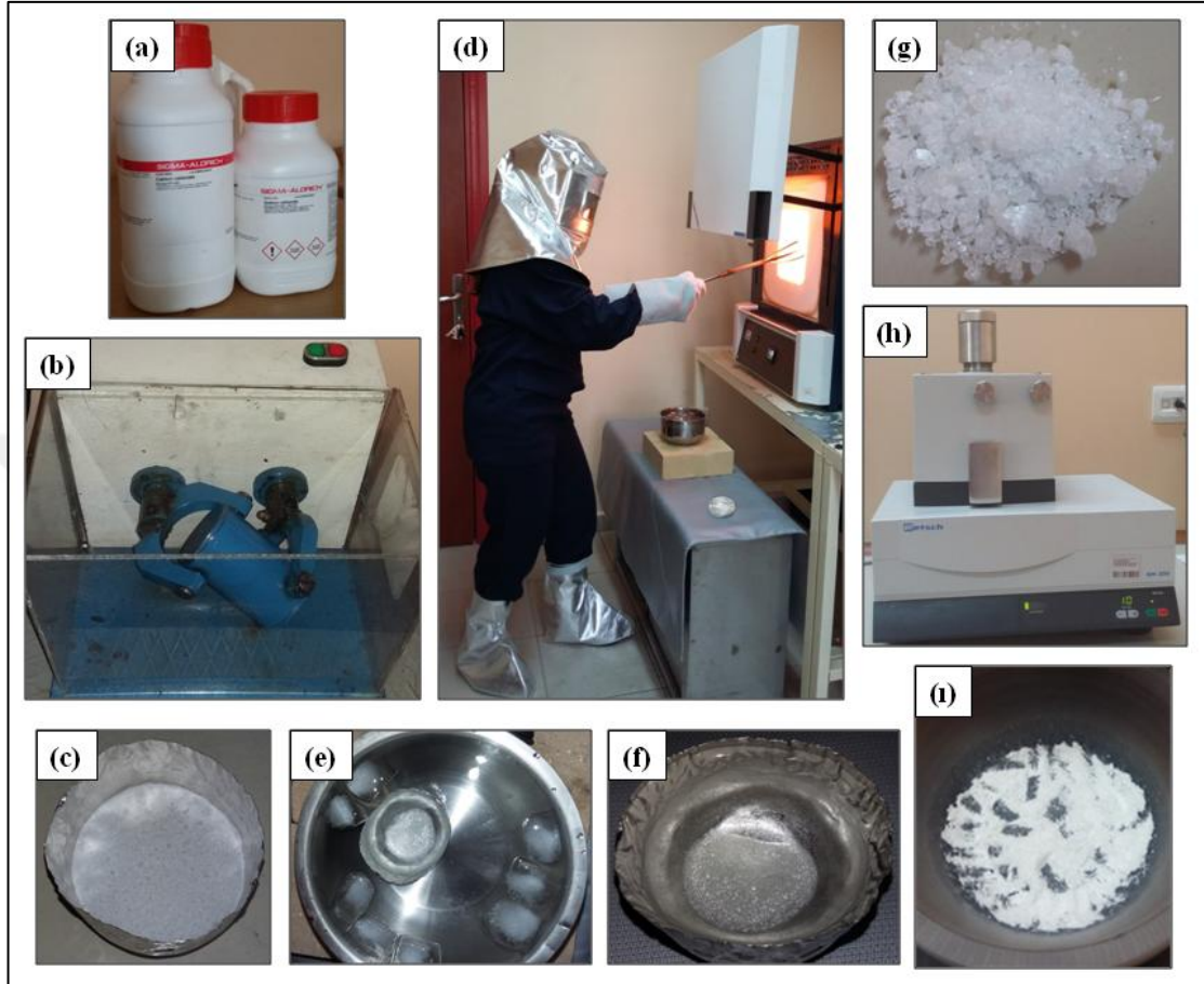
Şekil 3.7: (a-c) cam harmanının hazırlanması, (d-f) cam harmanını ergitme ve eriyiği ani soğutma aşamaları, (g-i) ani soğutma sonucu elde edilen cam parçalarının havan öğütücüde toz formuna ulaştırılması.
