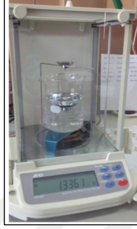
Şekil 3.10: % Açık gözeneklilik, % su emme ve bulk yoğunluk özelliklerinin belirlenmesinde kullanılan ve hassas terazi ile uyumlu olarak çalışan yoğunluk ölçüm kitinin fotoğrafı.
