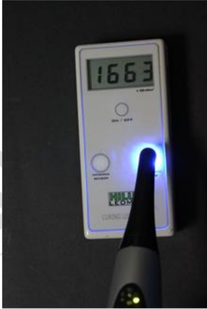
Şekil 3-7: LED ışık cihazının ışık yoğunluğunun dijital bir radyometre (Hilux Curing Light Meter, Benlioğlu Dental) kullanılarak ölçülmesi.
