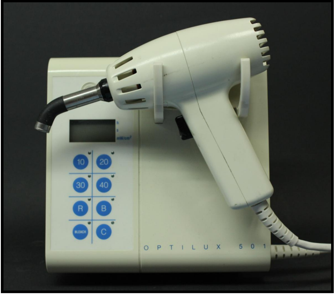
Şekil 3-4: Halojen (QTH) ışık cihazı (Optilux 501; Kerr Corp., Orange, CA, ABD)
