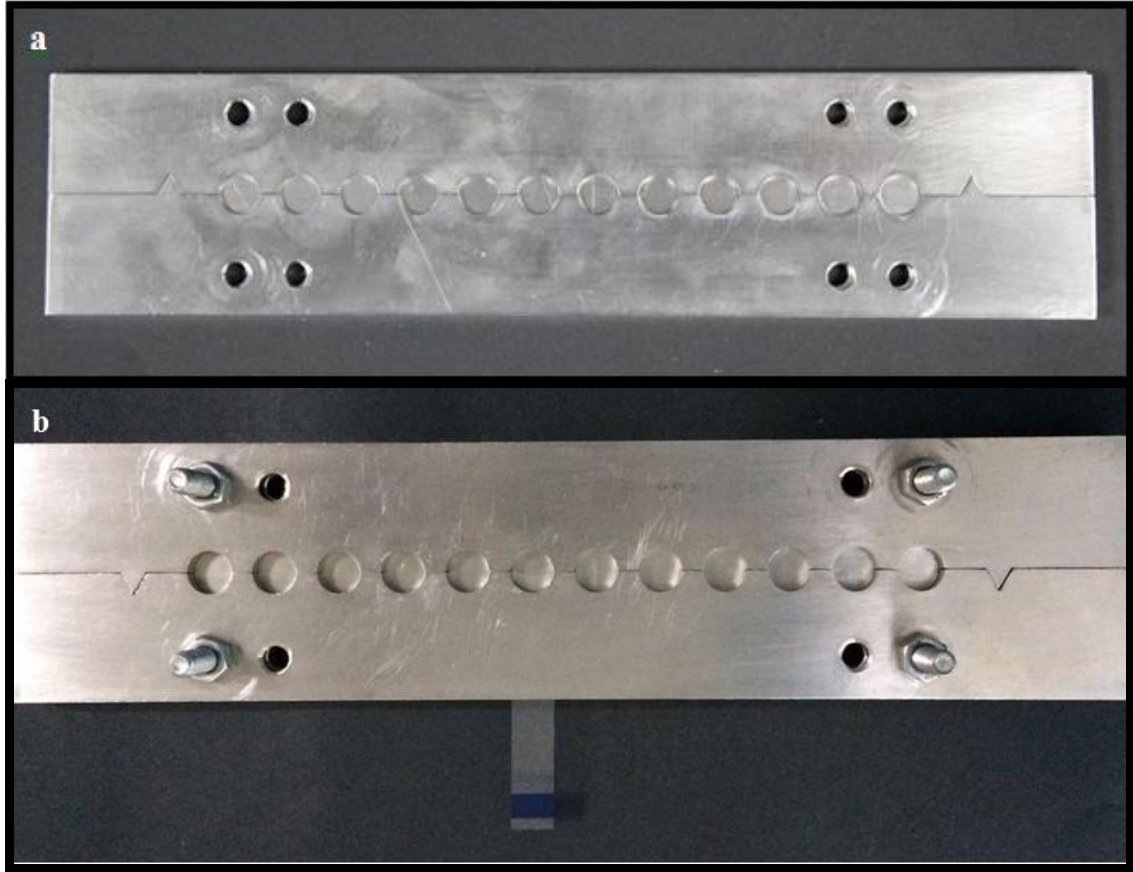
Şekil 3-10: a) Kompozit numunelerin hazırlanmasında kullanılan 8 mm çapında, 2, -4, 5 mm yüksekliğinde düz, pürüzsüz metal levha b) Materyallerin silindirik yuvalar içerisine yerleştirilmesi öncesinde metal tabla üzerine şeffaf bant yerleştirilmesi
