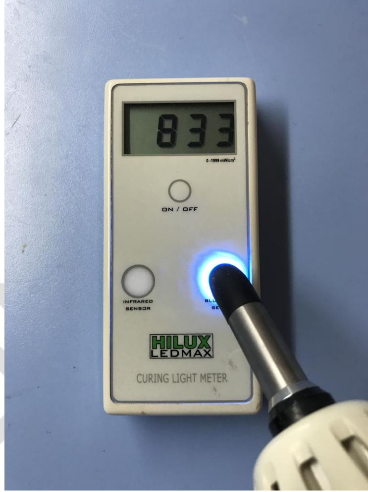
Şekil 3-5: QTH ışık cihazının ışık yoğunluğunun dijital bir radyometre (Hilux Curing Light Meter, Benlioğlu Dental, Ankara, Türkiye) kullanılarak ölçülmesi.
