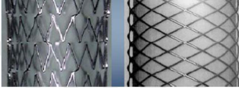
Şekil 3. Açık hücreli ve kapalı hücreli stent tasarımı 28
