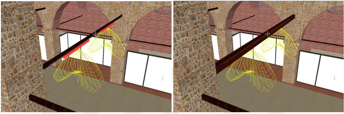
Şekil 7. 1 Genel aydınlatmada aygıt konumu- Alternatif 1: Dolaysız aydınlatma
