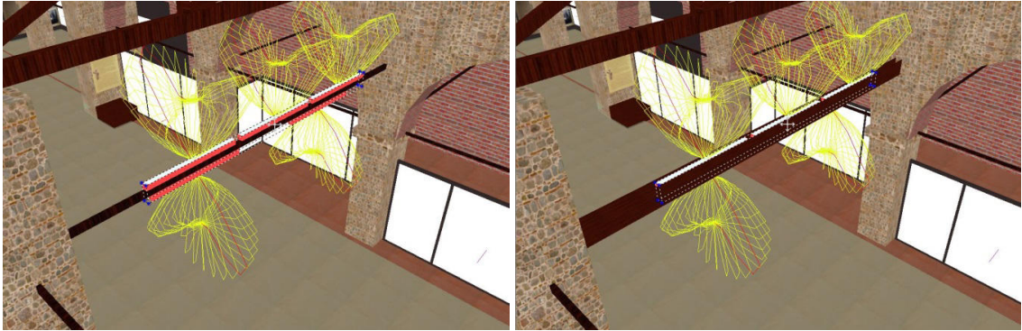
Şekil 7. 2 Genel aydınlatmada aygıt konumu- Alternatif 2: Dolaysız-dolaylı aydınlatma
