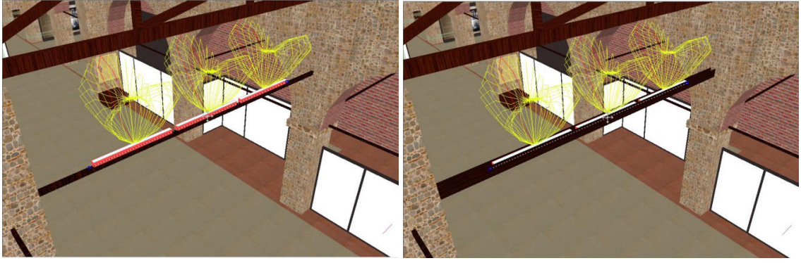
Şekil 7. 3 Genel aydınlatmada aygıt konumu- Alternatif 3: Dolaylı aydınlatma
