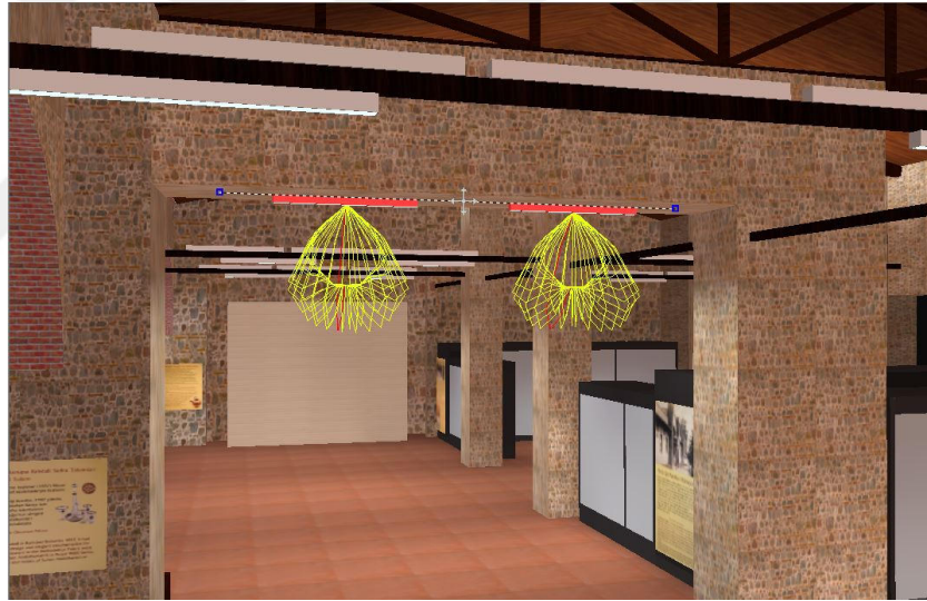
Şekil 7. 4 Tüm genel aydınlatma alternatiflerinde hacmin orta bölümündeki kiriş altında yer alan aygıtların konumu
