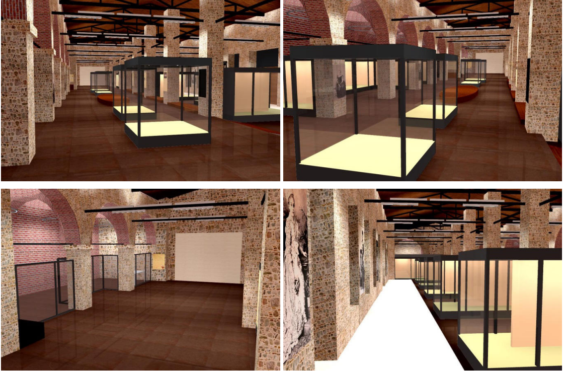
Şekil 7. 9 Genel aydınlatma- Alternatif 2: Dolaysız-dolaylı aydınlatma
