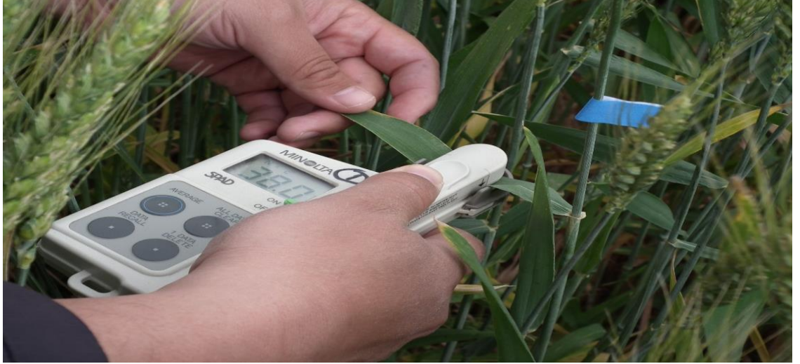
Şekil 3.21 Klorofil içeriğinin spadmetre yardımıyla ölçülmesi
