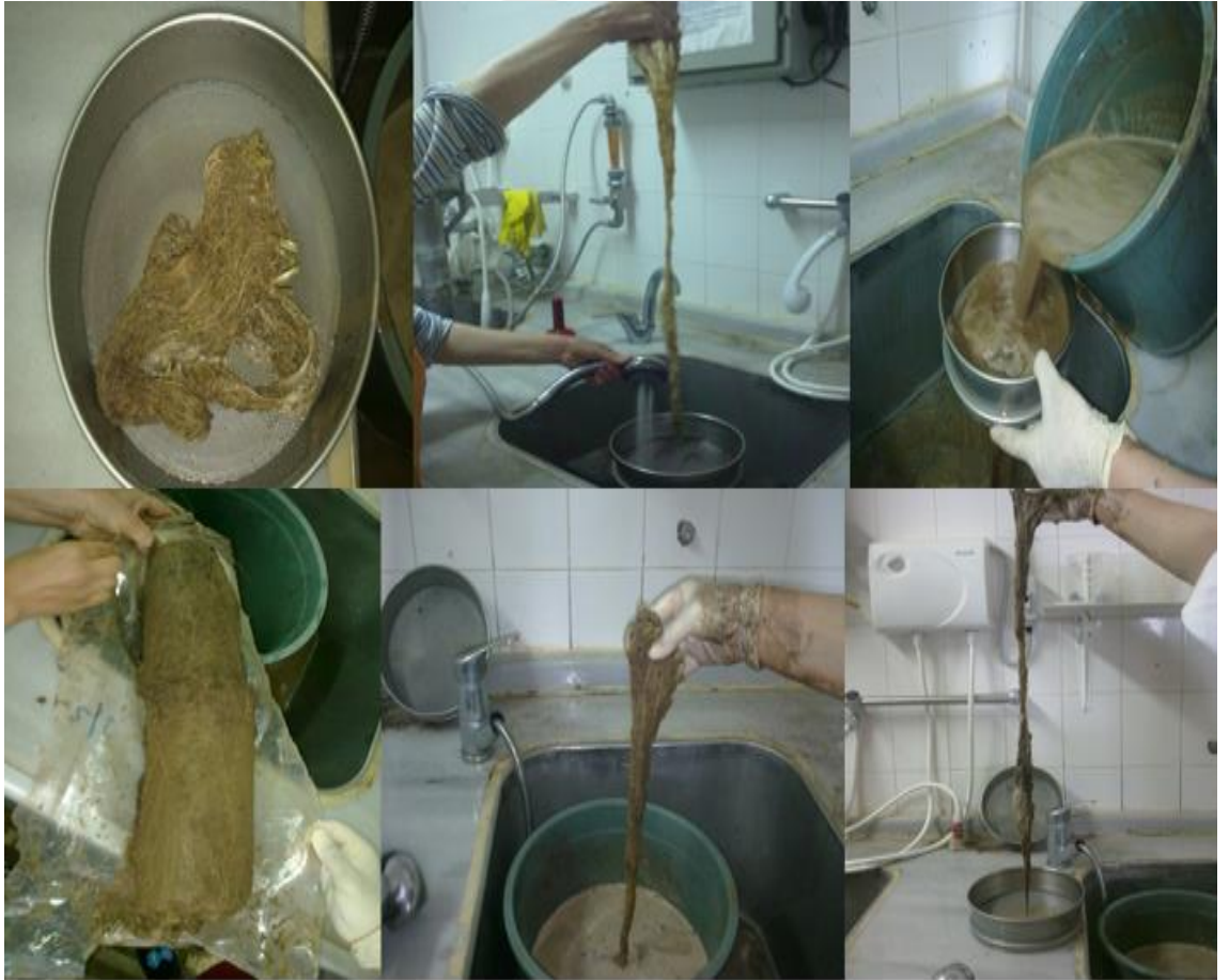
Şekil 3.12 Köklerin laboratuvarında yıkanma aşamaları
