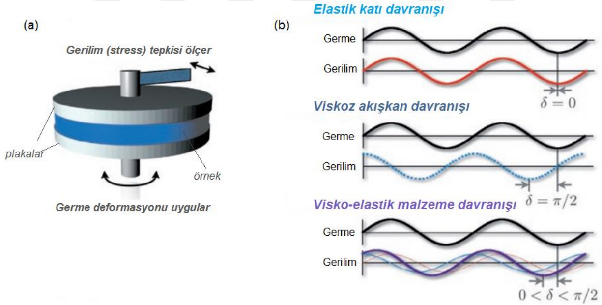
Şekil 7.5. (a) Analizi yapılacak örnek için reometre düzeneğinin şematik gösterimi, (b) salınımlı germe deformasyonu uygulanan elastik katı, viskoz akışkan ve visko-elastik malzemenin gerilim tepkisi sonucu oluşan faz kaymalarının şematik gösterimi [206].
