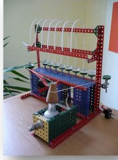
Şekil 2.1. Prof. Wichterle (1913-1998) (solda), kendisinin geliştirmiş olduğu yumuşak kontakt lens üretiminde kullanılan santrifüjlü dökme aparatı (ortada), PHEMA esaslı kontakt lens (sağda).
