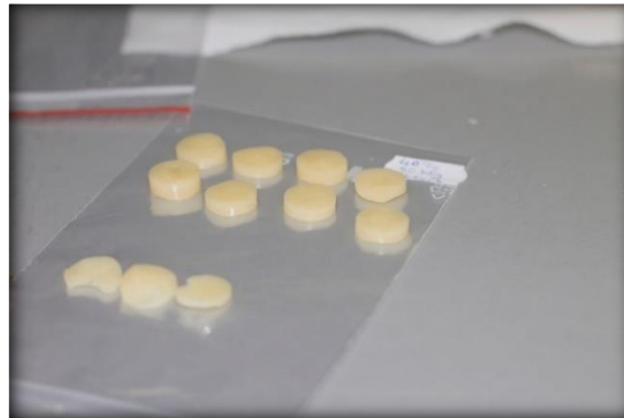
Şekil 10.4. Hamur kıvamında hazırlanan ksantan sakızı polimerinin ışınıldıktan sonra kurutulmak üzere hazırlanması.
