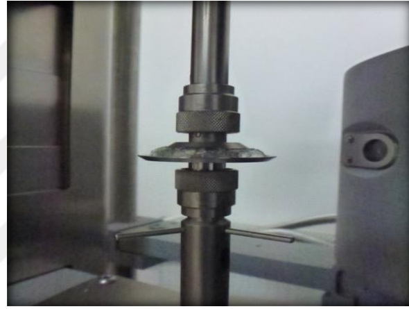
Şekil 8.3. Thermo-Haake (MARS) reometre (üstte), hidrojenlerin reolojik analizleri için kullanılan paralel plaka düzeneği (altta).
