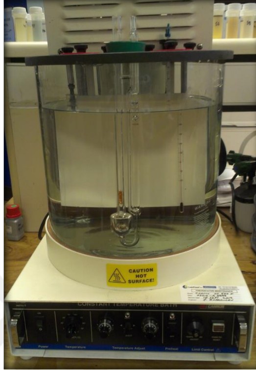
Şekil 9.34. Viskozitelerin belirlenmesinde kullanılan kalibre edilmiş Ubbelohde viskometresi (Cannon Ubbelohde Semi-Micro Calib 75).
