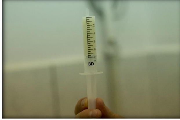
Şekil 10.2. Hamur kıvamında hazırlanan ksantan sakızı polimerinin ışınlanmak üzere şırıngaya yerleştirilmesi.
