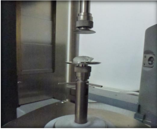
Şekil 8.3. Thermo-Haake (MARS) reometre (üstte), hidrojenlerin reolojik analizleri için kullanılan paralel plaka düzeneği (altta).
