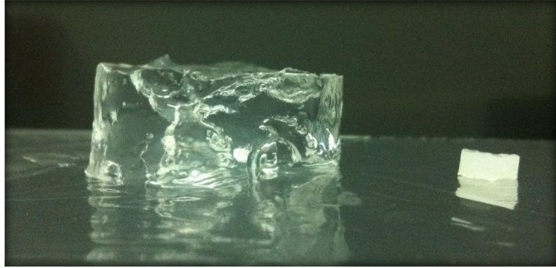
Şekil 10.8. Hazırlanan ksantan sakızı/AACNa jellerinden en yüksek şişme kapasitesine sahip jelin kuru haldeki (sağ) ve denge şişme seviyesine ulaşmış haldeki (sol) görüntüsü.
