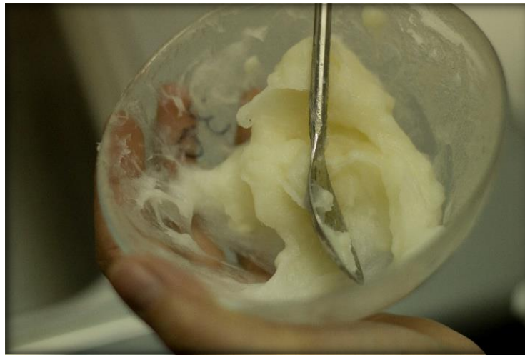
Şekil 10.1. KS polimerinin hamur kıvamındaki çok derişik çözeltilerinin hazırlanması.
