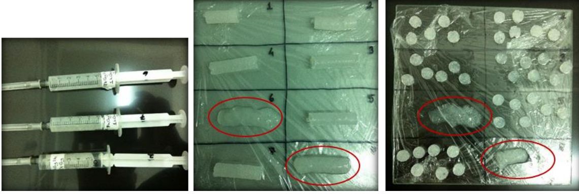
Şekil 10.7. 7,0 kGy/sa. doz hızında ışınlanarak hazırlanan KS/AACNa hidrojellerinin ışınlama sonrası ilk hallerinin (sol ve orta) ve silindir şeklinde dilimlenmiş hallerinin (sağ) görüntüsü.
