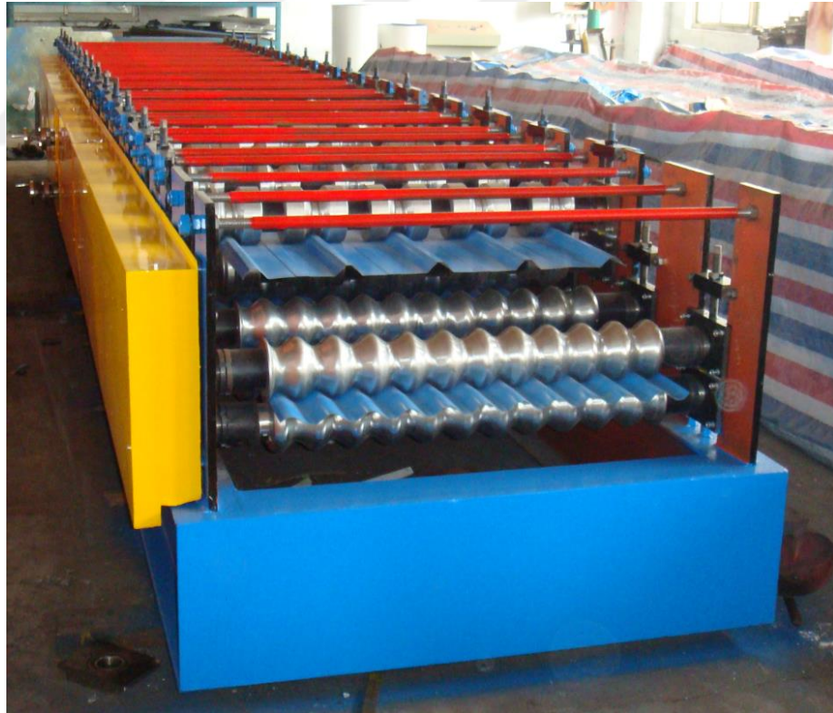
Şekil 1.5 : Roll form makinesi
