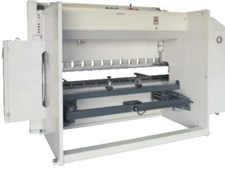
Şekil 1.6 : Abkant pres makinesi
