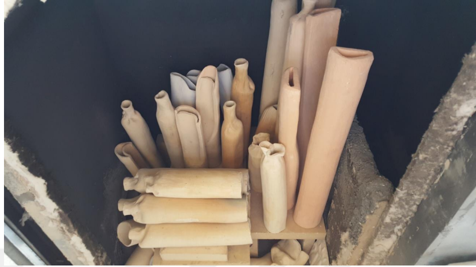
Fotoğraf 2.51. Odun pişirimi öncesi fırın içi yerleştirme düzeni
