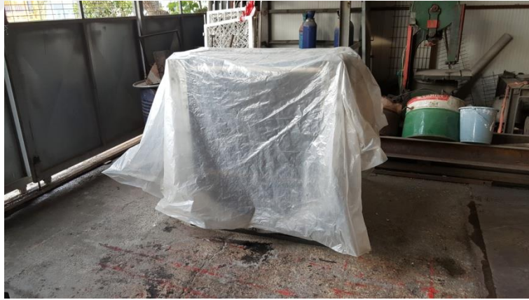
Fotoğraf 2.27. Döküm sonrası sıcaklık koruması
