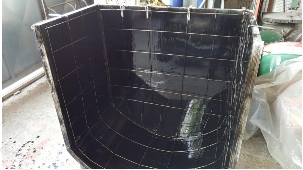
Fotoğraf 2.22. Kalıp ayırıcı yağ kullanımı
