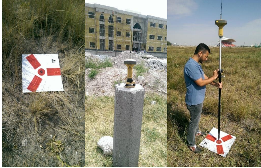
Şekil 4.3: a) Yer kontrol noktası b) Sabit GNSS alıcısı c) Gezici GNSS alıcısı
