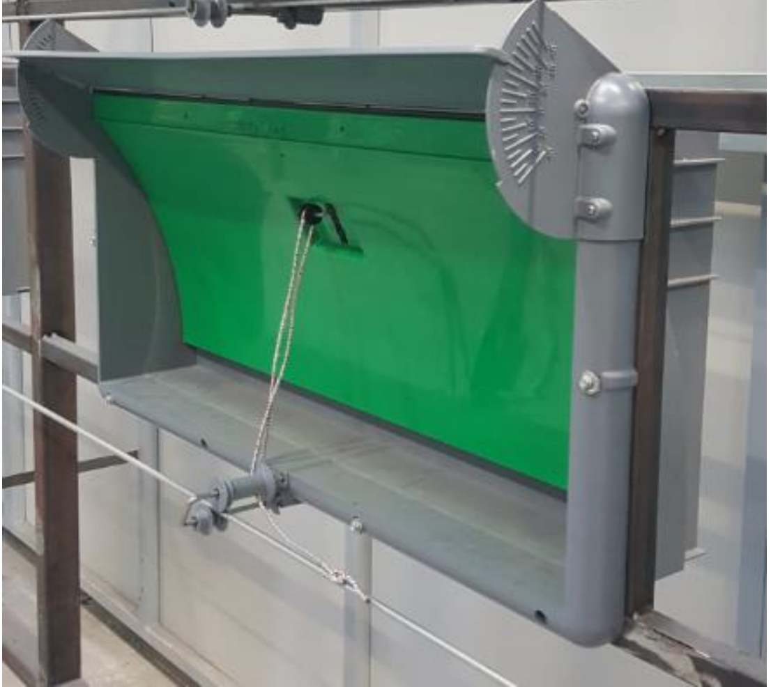
Şekil 4.35. Kapağın test düzeneğine monte edilmesi
