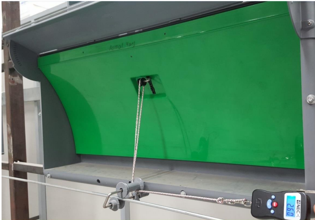
Şekil 4.3. Test düzeneği ve kuvvet ölçümü
