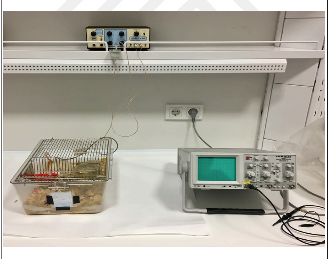
Şekil 3.3 Stimulator, Oskiloskop ve Stimulasyon Düzenneđi
