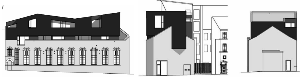
Şekil 3.10 Sheffield Shoreham'da Kırmızı Tuğladan Yapılmış Olan Viktorya Dönemine Ait Bir Endüstri Yapısı Siyah Metal Plaklarla Yükseltilmiş Ek Çatı Yapısı (URL-13, 2016)
