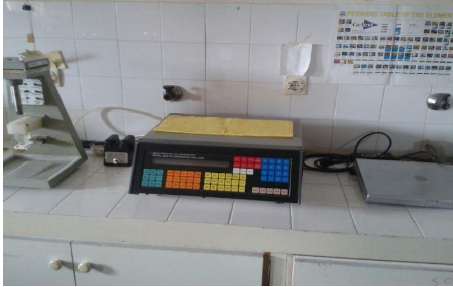
Şekil 3.1.2.2. EGveG PARC Model 303A SMDE polarografik hücreye (Princeton, NJ, USA) bağılı EGveG PAR Model 384B polarografik analizör cihazı
