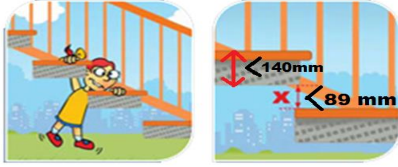
Şekil 4.9 : Merdiven basamak ve boşluk sınır ölçüleri (Url-21).
