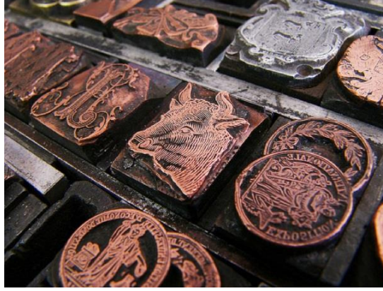
Çeşitli görsellerin çinkograflar tarafından yapılmış baskıya hazır çinko kalıpları. 59
