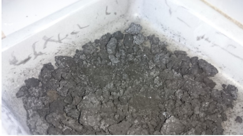
Şekil 4.5. Yıkama ve kurutma işleminin ardından kömür üzerinde kalan inorganik safsızlıklar
