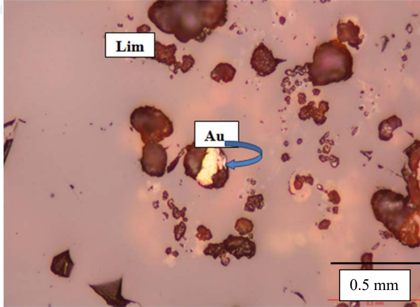
Şekil 4.20. Limonit (lim, kırmızımsı iç yansımali lepidokrokit) içerisinde nabit altın (Au, parlak sarı).
