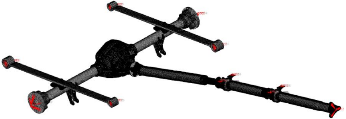
Şekil 6. 15 Aksın Süspansiyon Braketi ve Aks Millerinden Sabitlenmesi
