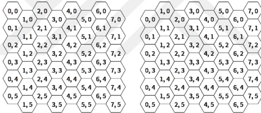
Şekil 4.4. Tek Sütunların Kaydığı (Solda), Çift Sütunların Kaydığı (Sağda) Dikey Örgü Yapıları
