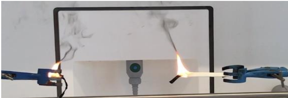
řekil 4.15 : 12. sn PUF1 yanma testi (Sać; katkılı PU-Sol; saf PU).
