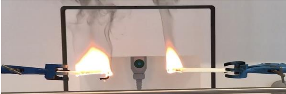
řekil 4.14 : 6. sn PUF1 yanma testi (Sać; katkılı PU-Sol; saf PU).
