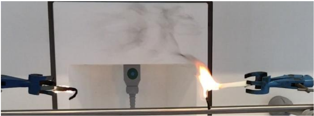
Şekil 4.19 : 12. sn PUF2 yanma testi (Sağ; katkılı PU-Sol; saf PU).
