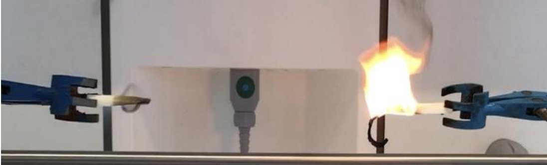
Şekil 4.22 : 12. sn PUF3 yanma testi (Sağ; katkılı PU-Sol; saf PU).
