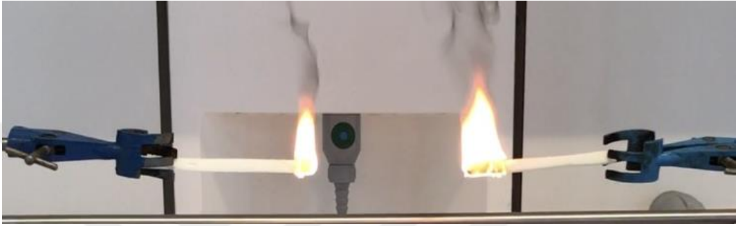
Şekil 4.17 : PUF2 yanma testi (Sağ; katkılı PU-Sol; saf PU).
