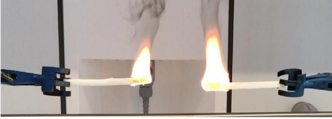
Şekil 4.20 : PUF3 yanma testi (Sağ; katkılı PU-Sol; saf PU).
