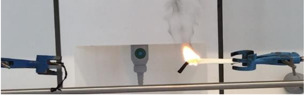
Şekil 4.16 : 18. sn PUF1 yanma testi (Sağ; katkılı PU-Sol; saf PU).
