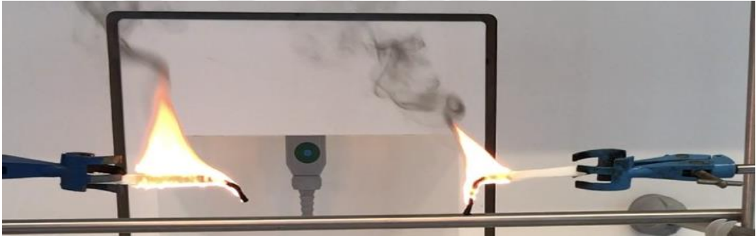
Şekil 4.18 : 6. sn PUF2 yanma testi (Sağ; katkılı PU-Sol; saf PU).
