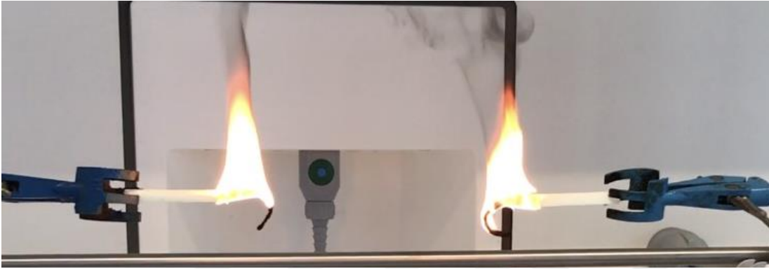
Şekil 4.21 : 8. sn PUF3 yanma testi (Sağ; katkılı PU-Sol; saf PU).
