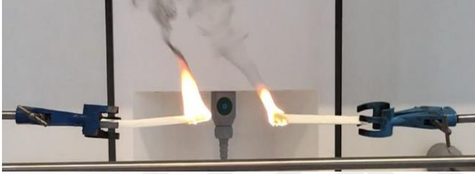
řekil 4.13 : PUF1 yanma testi (Sać; katkılı PU-Sol; saf PU).
