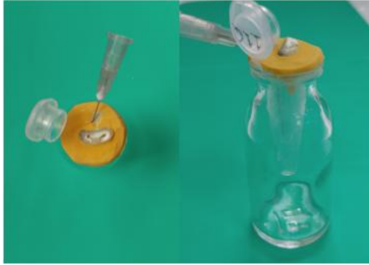
Şekil 3.2. Apikal taşan debrisin toplanacağı düzenek
