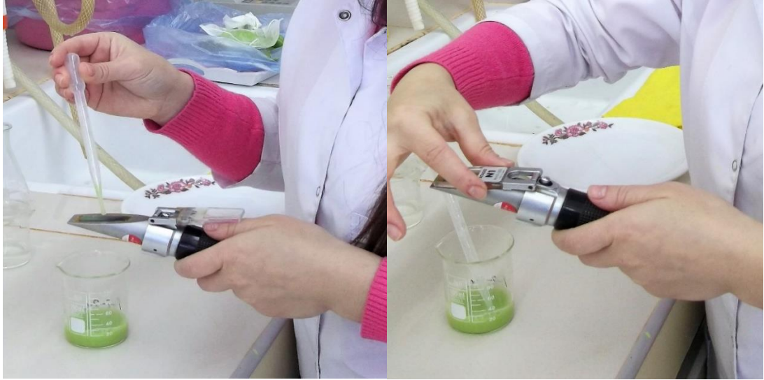
Şekil 3.29. Meyve suyu örneklerinde SÇKM ölçümünden bir görünüm
