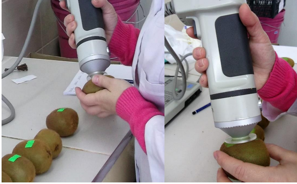
Şekil 3.30. Meyve eti ve meyve kabuğunda renk ölçümünün yapılmasından bir görünüm
