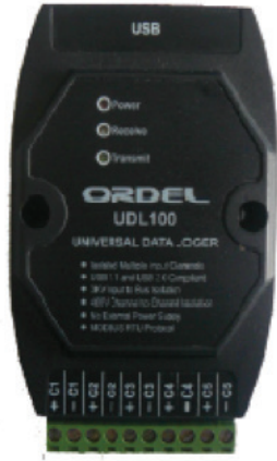
Şekil 3.9. a) 5 kanallı data logger kart görünümü, b) 15 kanallı data logger cihazı görünümü
