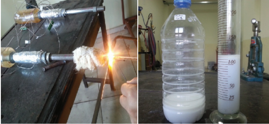
Şekil 3.12. a) Isı boruları farklı evaporatör doluluk oranı imalat görünümü, b) Nano-akışkan ölçüm görünümü
