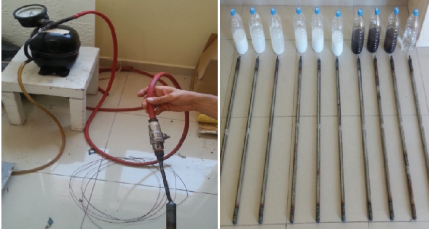
Şekil 3.5. a) Vakum işlemi görünümü, b) 10 adet ısı borusu görünümü
