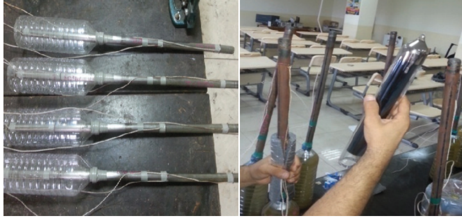
Şekil 3.6. a) Plastik şişe uygulama görünümü, b) Vakum tüp cam kollektör uygulama görünümü
