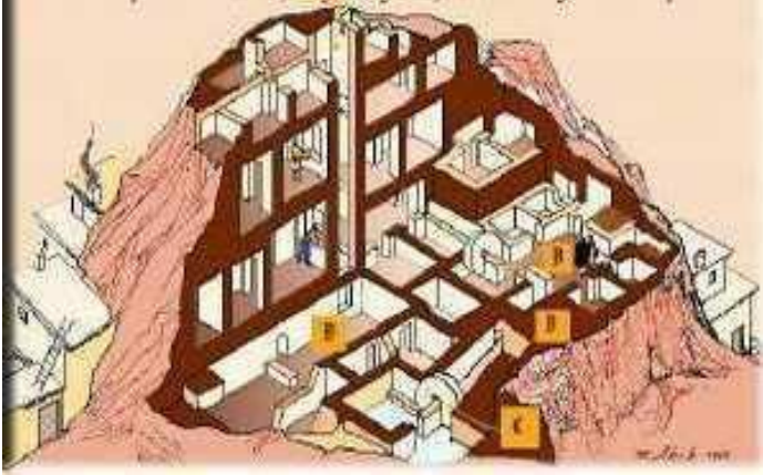
Şekil 1.1. Yer altı şehri kesiti (Demir, 1968)
