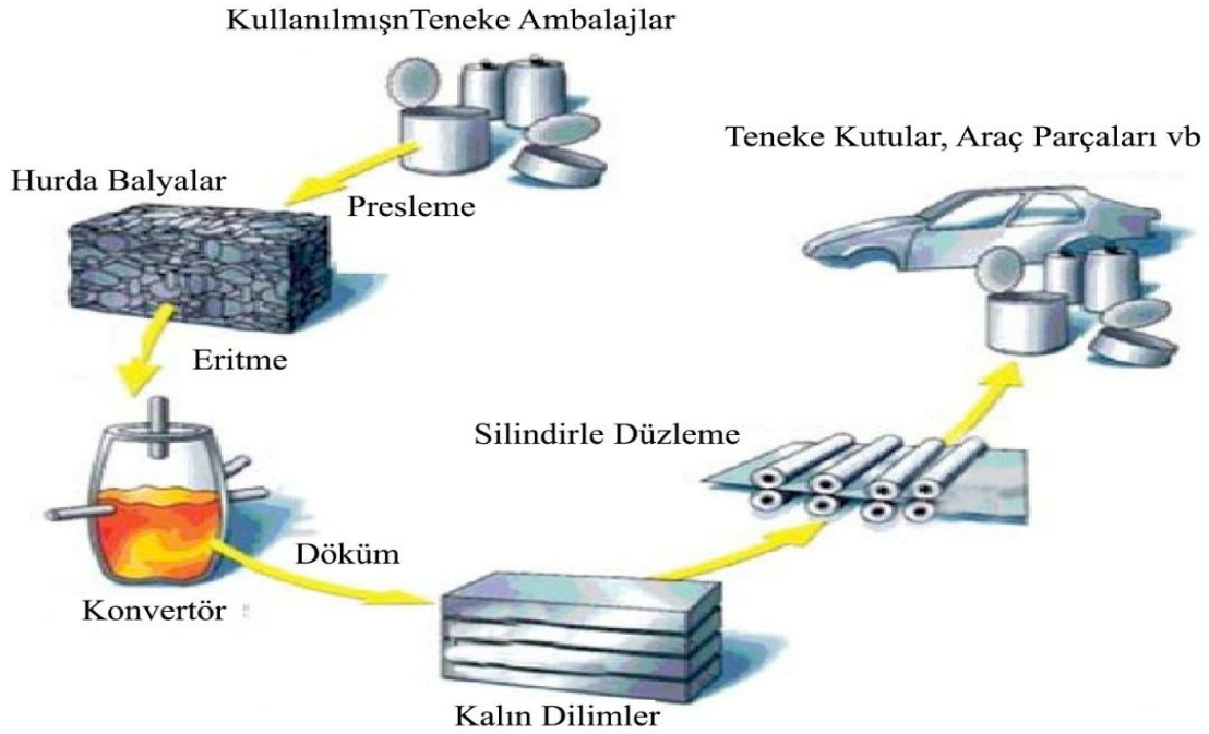
Şekil 2.5. Metal geri kazanım akış şeması (Karamangil, 2008)
