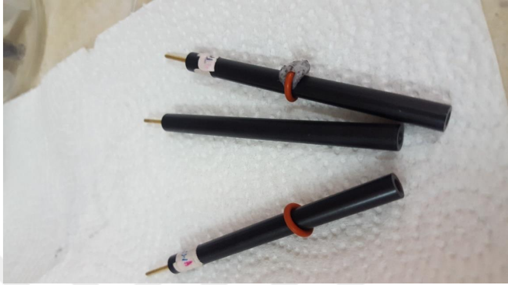
Şekil 3.3 Karbon pasta elektrot gövdesi
