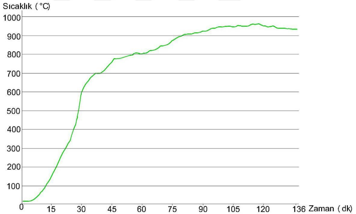
Şekil 5.30. 136 dakikalık deneye ait sıcaklık- zaman grafiği (tarafımdan çizilmiştir.)
