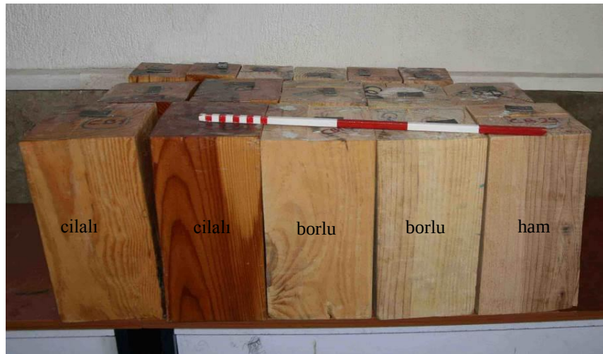
Şekil 5.9. Yangın geciktirici uygulanmış ahşaplar (30.6.2016)
