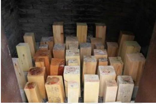
Şekil 5.16. Ahşap numunelerin yangın odasına yerleştirilmesi (30.6.2016)
