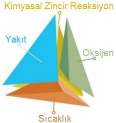
Şekil 2.2. Yangın tetrahedronunu gösteren model (Koopman, 2013)
