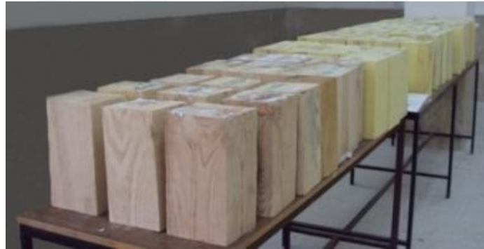
Şekil 5.27. Yüzey hazırlığı tamamlanmış ahşap numune örnekleri (1.12.2012)
