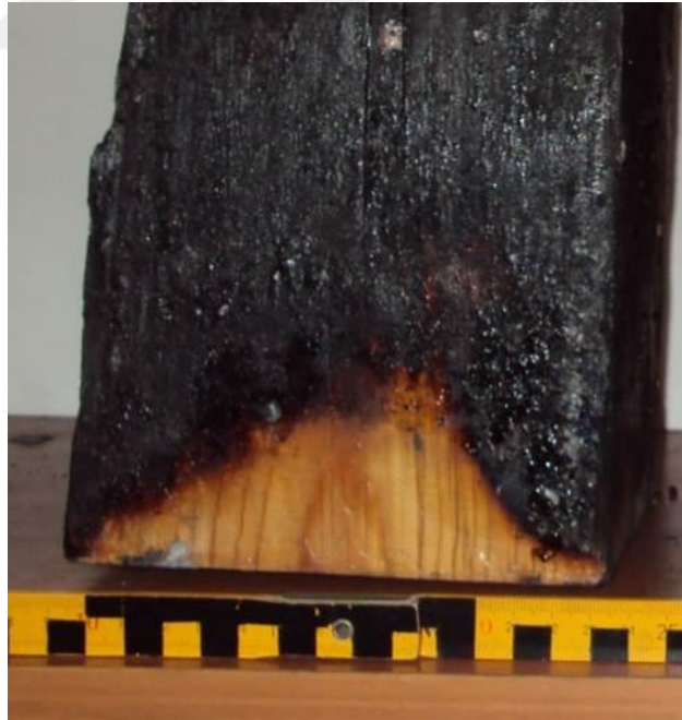
Şekil 5.6. Yangın geciktirici kimyasalın yangın esnasında ahşap yüzeyinde oluşturduğu kabarcıklar ve şişme (30.6.2016)
