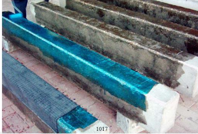
Şekil 1.2 CFRP ile güçlendirilmiş kirişler
