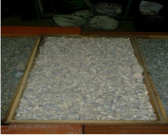
Şekil 3.17 Los Angeles deneyi için numunelerin hazırlanması.
