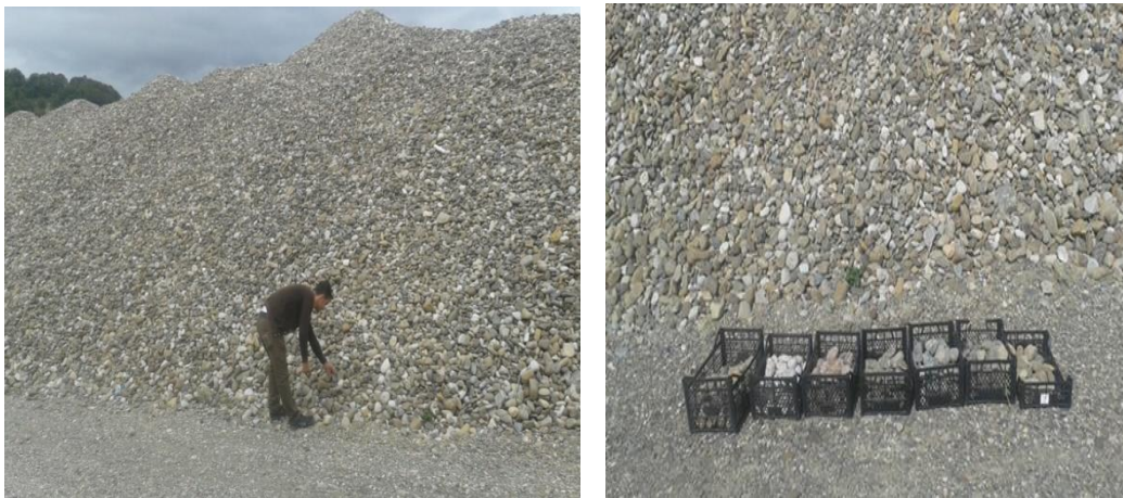
Şekil 3.3 Arazide numunelerin litojilerine göre ayırma işlemi.
