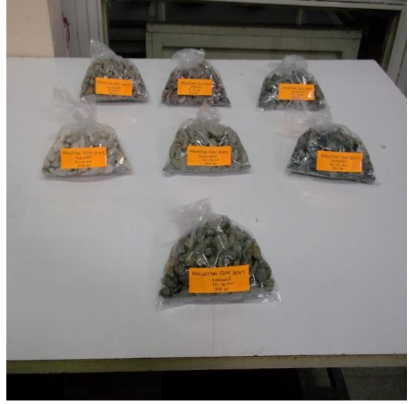
Şekil 3.32 Magnezyum sülfat ( MgSO_4 ) deneyi için numunelerin hazırlanması.
