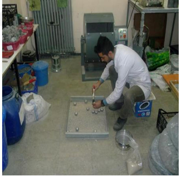
Şekil 3.20 Los Angeles aşınma dayanımı deney aşamaları.
