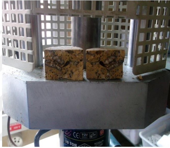
Şekil 3.26 Nokta yükü dayanım indeksi deney aşamaları.
