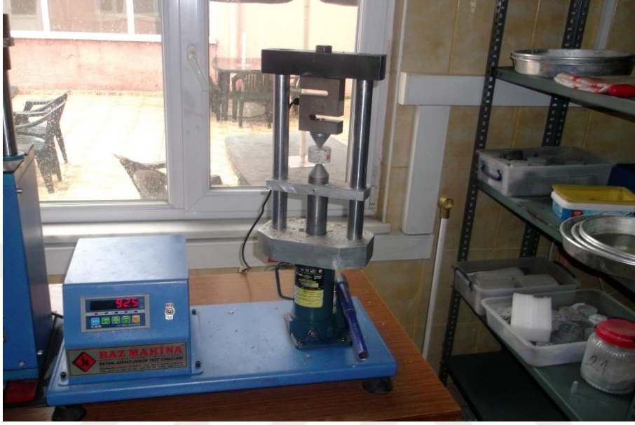
Şekil 3.25 Nokta yükü dayanım indeksi deney aleti.
