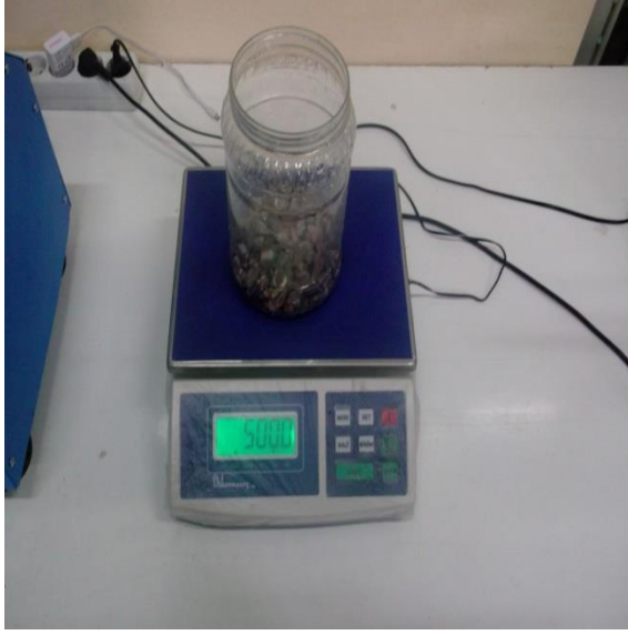
Şekil 3.32 Magnezyum sülfat ( MgSO_4 ) deneyi için numunelerin hazırlanması.
