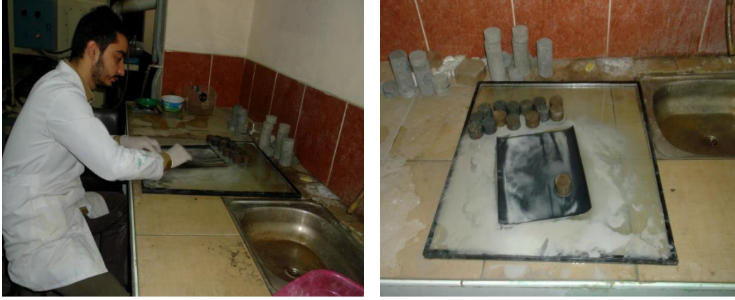
Şekil 3.8 Numunelerden pürüzsüz yüzey elde edilmesi.
