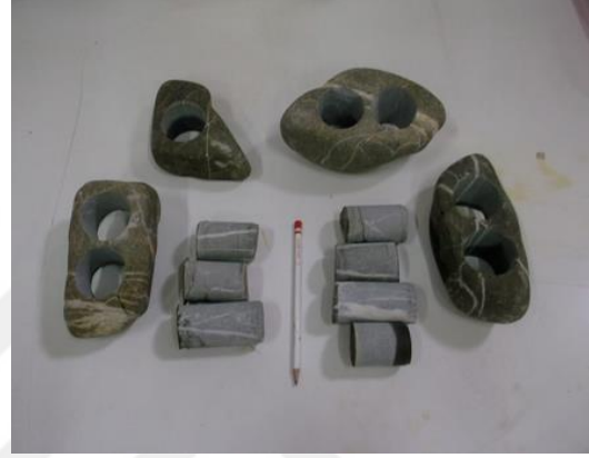
Şekil 3.6 Numunelerden karot alma işlemi.
