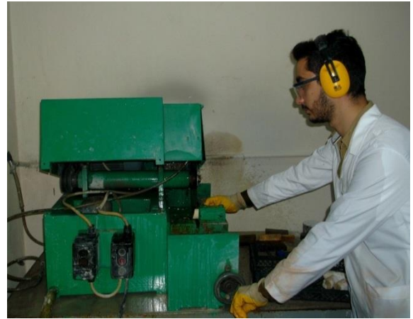
Şekil 3.7 Karotların disk kesici ile boyutlarının kesilmeleri.
