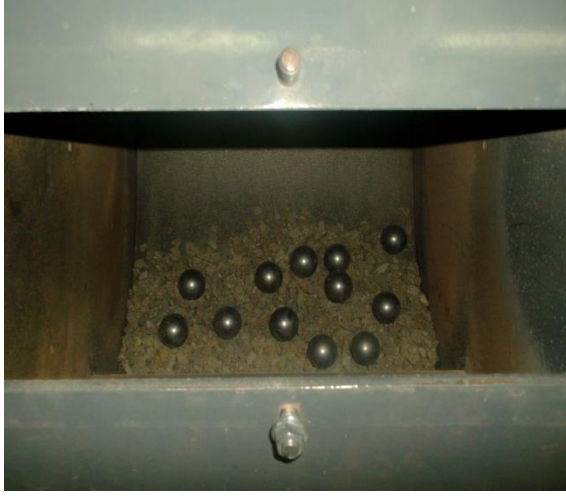
Şekil 3.19 Agregaların tambura konulması ve tepsiye dökülmesi.
