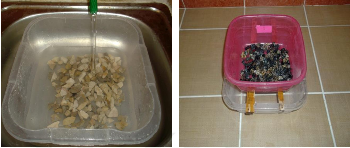
Şekil 3.36 Numunelerin magnezyum sülfattan arındırılması.
