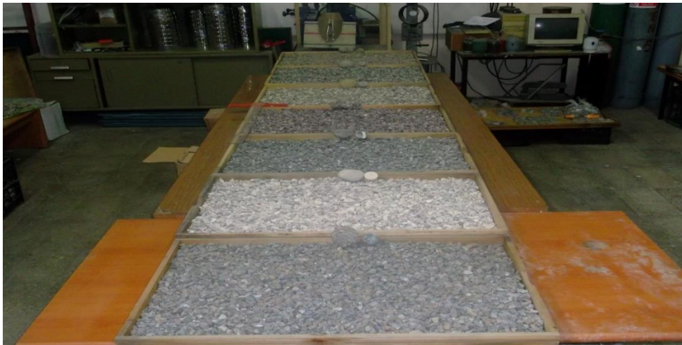
Şekil 3.12 Petrografik incelemeler sonucunda 7 farklı litolojiye ayrılan ve hazırlanan agrega çakıl numuneleri.
