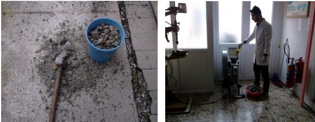
Şekil 3.4 Numunelerin balyoz ve çeneli kırıcı ile kırma işlemi.
