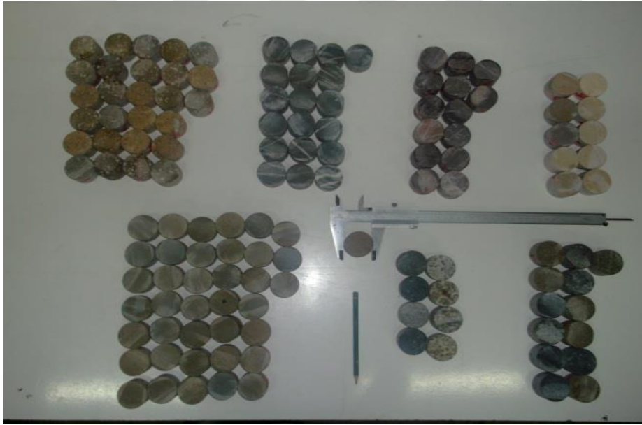
Şekil 3.9 Numunelerin kumpas ile ölçülmesi.
