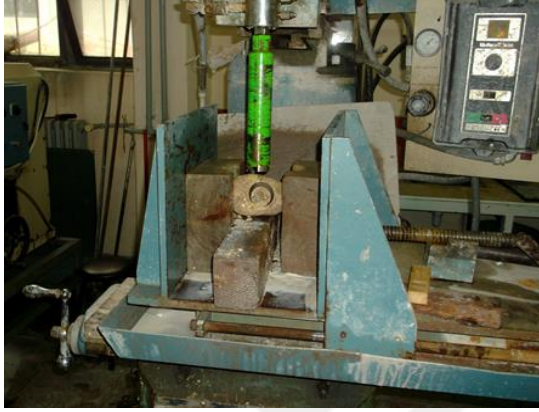
Şekil 3.6 Numunelerden karot alma işlemi.
