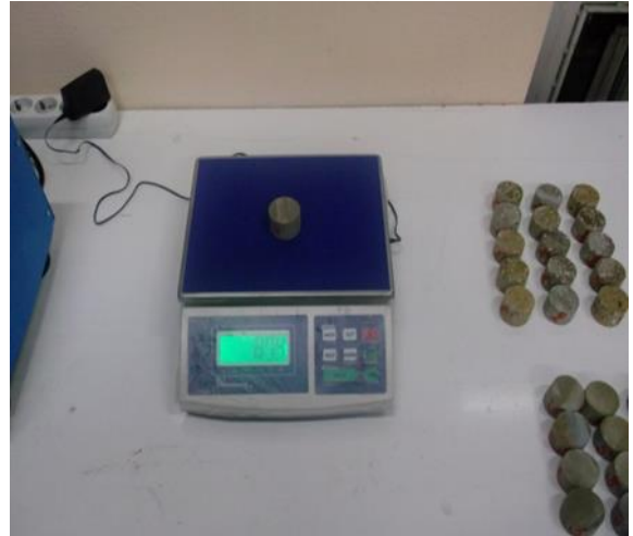
Şekil 3.14 Numunelerin desikatörde suyun içinde bekletilmesi ve tartımı.
