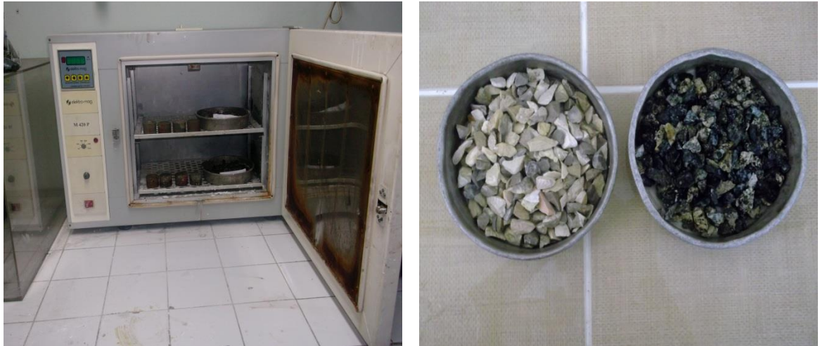
Şekil 3.35 Numunelerin etüvde kurutulmaları ve soğutulması.
