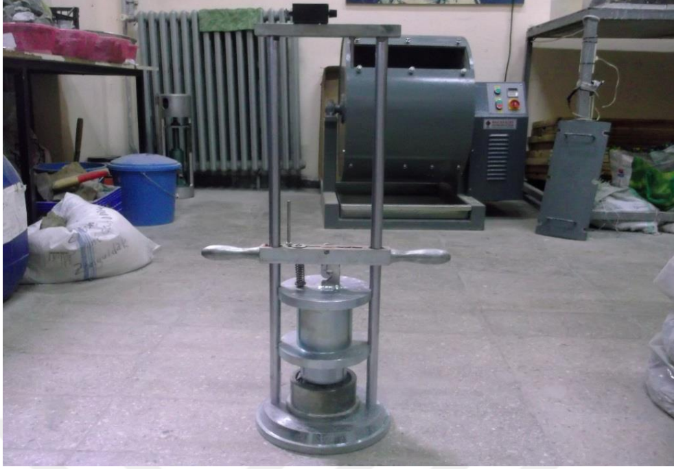
Şekil 3.22 Darbe dayanım indeksi deney aleti.
