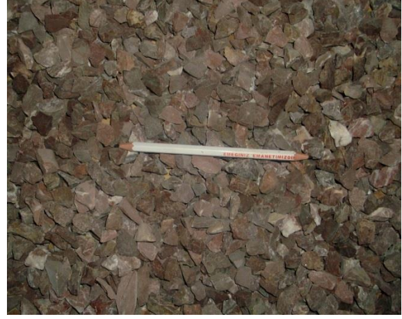
Şekil 3.17 Los Angeles deneyi için numunelerin hazırlanması.
