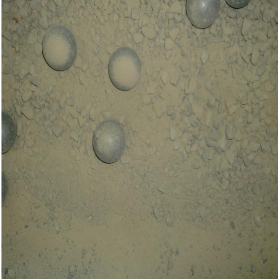
Şekil 3.20 Los Angeles aşınma dayanımı deney aşamaları.
