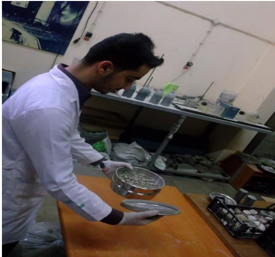
Şekil 3.23 Agrega darbe dayanım indeksi deneyi aşamaları.
