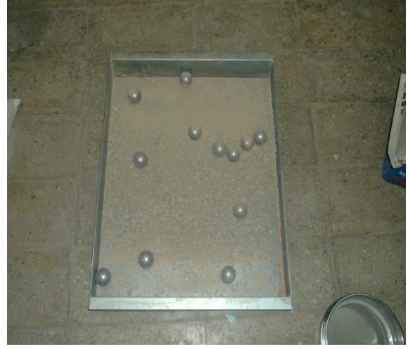
Şekil 3.19 Agregaların tambura konulması ve tepsiye dökülmesi.
