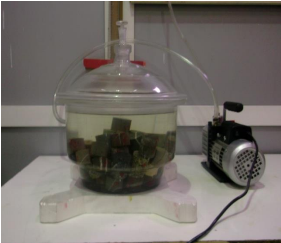
Şekil 3.14 Numunelerin desikatörde suyun içinde bekletilmesi ve tartımı.
