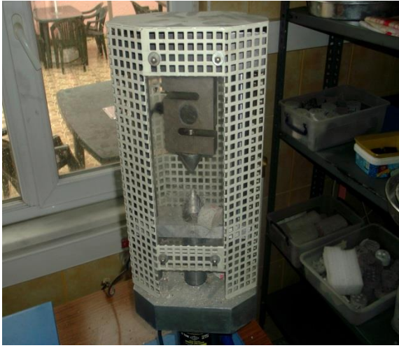
Şekil 3.26 Nokta yükü dayanım indeksi deney aşamaları.
