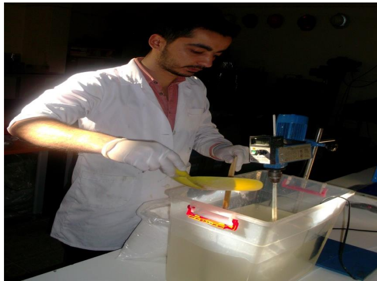
Şekil 3.33 Doymuş magnezyum sülfat çözeltisi hazırlanması.
