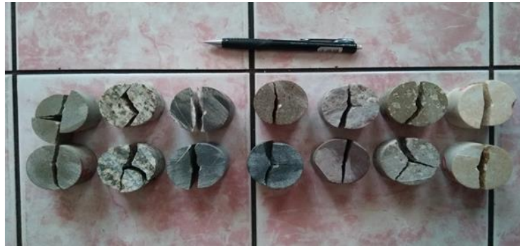
Şekil 3.27 Nokta yükü dayanım indeksi sonucu kırılmış numuneler.
