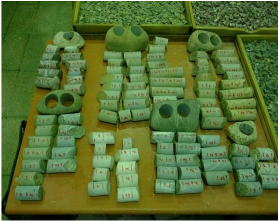
Şekil 3.7 Karotların disk kesici ile boyutlarının kesilmeleri.
