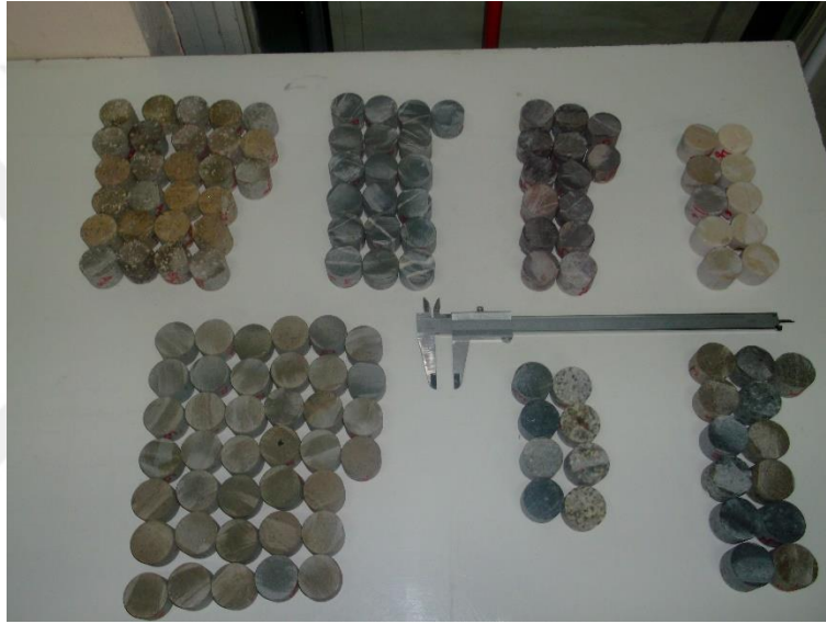
Şekil 3.13 Fiziksel özellikler deneyleri için hazırlanan disk şeklindeki karot numuneleri.
