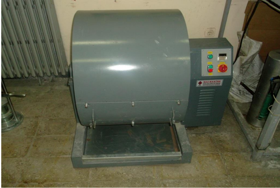
Şekil 3.18 Los Angeles deney makinesi.
