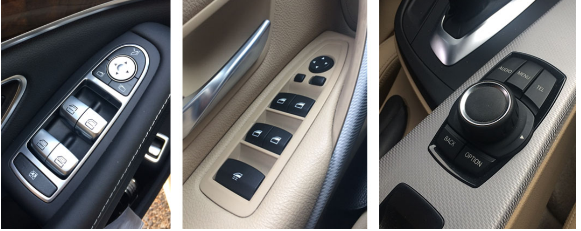
Şekil 5.3 Sol taraf ve ortada çoğu araçta benzer konum ve tasarımda olan cam açma – kapama üniteleri. Mantıksal olarak doğru gruplanmış gibi gözükseler dahi, kontrollerin birbirine benzerliği haptik algılanabilirlik açısından karmaşıklık yarattığı söylenebilir. Sağ tarafta görülen konsol üzerine konumlanmış ekranı kontrol eden knob kontrol ünitesi ise, form ve boyut bakımından bulunduğu alanda radikal bir farklılık yarattığından dolayı haptik algılanabilirlik seviyesi oldukça yüksektir.
