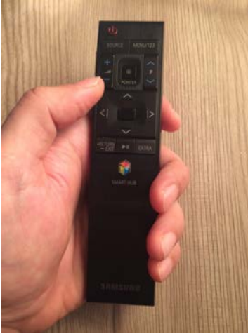
Şekil 1.16 Zenginleşen taktıl etkileşim örnekleri. Soldaki resimde işaretleyicili (pointer) tv kumandası görülmektedir. Dokunsal fonksiyonların yanında el hareketleri(gesture) ile kontrol görevi yüklenmiştir. Sağdaki resimde ise 3d connexion firmasının 3 Boyutlu uygulama çevrelerinde kullanılmak üzere tasarladığı ürün görülmektedir. Ortadaki silindirik kontrol çok boyutlu sanal etkileşim sağlamaktadır.
