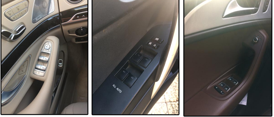
Şekil 1.22 Farklı araçlarda benzer konum ve düzende bulunan cam açma-kapama kontrol ünitesi örnekleri. Ancak bu ünitenin çevresindeki kontrol ünitelerinin yine farklı tasarım niteliklerine sahip olduğunu söylenebilir.
