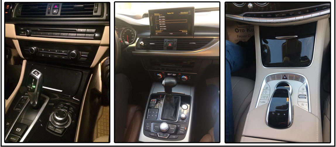
Şekil 1.20 Farklı araçların konsol arayüzleri. Ortadaki ve sağdaki örnekte dokunmatik ve mekanik özellikli kontrol elemanları beraber kullanılmıştır. Soldaki örnekte ise sadece mekanik özellikli kontrol elemanları görülmektedir.
