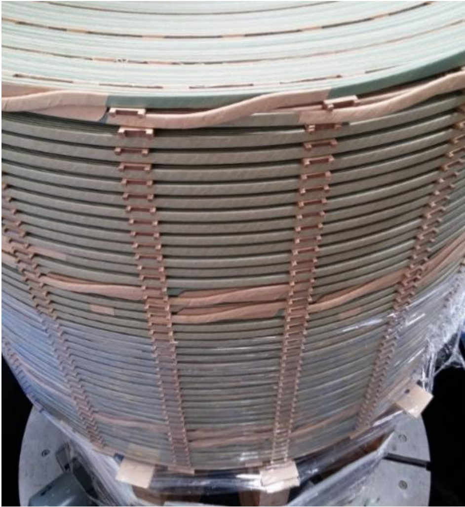
Şekil 2.12 : İç içe geçmiş disk sargı şematik gösterimi ve fotoğrafı. Geçiş yerleri işçiliği ilk diskte gösterilmiştir.
