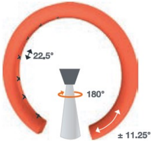
Şekil 5.2. Antenin azimut ve yükselme düzlemi ölçümü [33]
