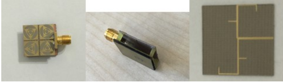
Şekil 4.19. Üretilen antenin (a) topraklama yüzeyi (b) yan yüz (c) besleme yüzeyi görüntüleri
