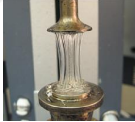
Şekil 3.16: Malzemenin paralel plakalar arasındaki tam olarak erimiş hali.
