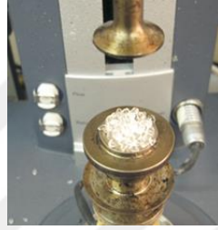
Şekil 3.15: Malzemenin alt plakaya yerleştirilmesi.
