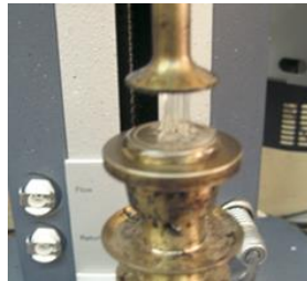
Şekil 3.17: Malzemenin paralel plakalar arasında katılaşmaya başlaması.
