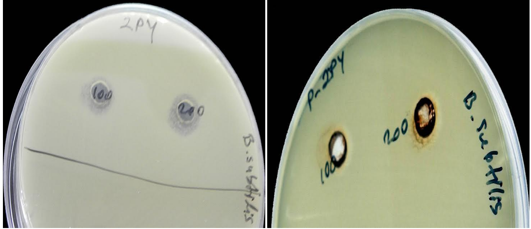
Şekil 4.9 2-PMBDA ve Poli(2-PMBDA)'in B.subtilis ATCC 6633'ya karşı antimikrobiyal etkinliğinin zone çapı ile gösterimi
