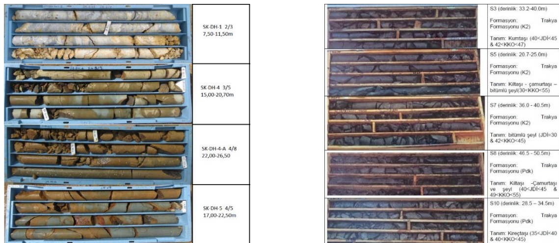
Şekil 3.1 Üsküdar- Çekmeköy Metro Hattı'na ait zemin formasyonu numuneleri [15]
