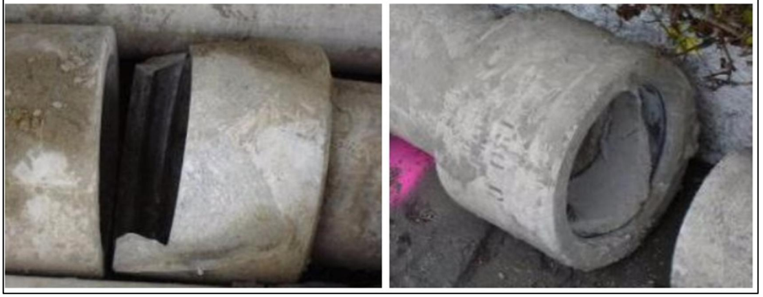
Şekil 2.14: AC tipi borularda kırılma (Black 2013, fotoğraf; F. O'Callaghan)
