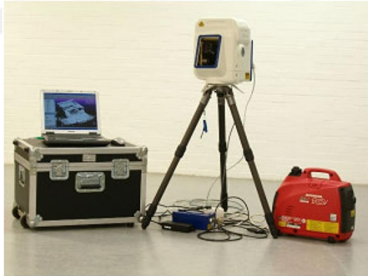
Şekil 3.2: Yersel (terrestrial) tarama (Kertsen 2004)
