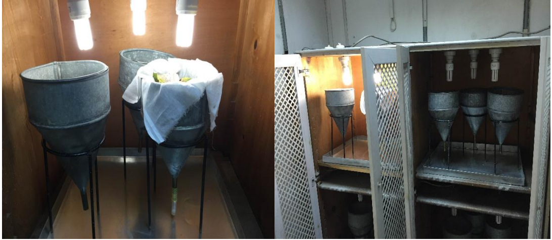
Şekil 3.5 Akarların ekstraksiyonunda kullanılan Berlese hunileri
