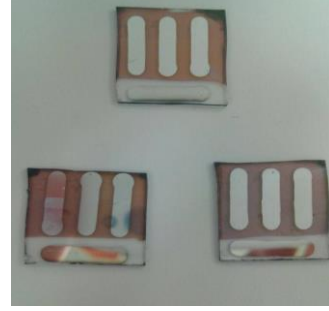
Şekil 5.37 Oluşturulan organik güneş pili yapısı [64]
