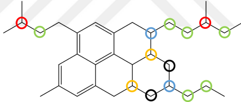
Şekil 3.18: Benzilik, aromatik ve metil formunda olmayan hidrojen grupları.
