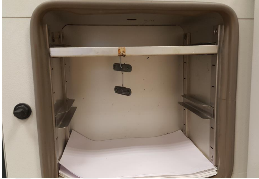
Şekil 2.9. Kalıcı şekle geri gelme basamağı
