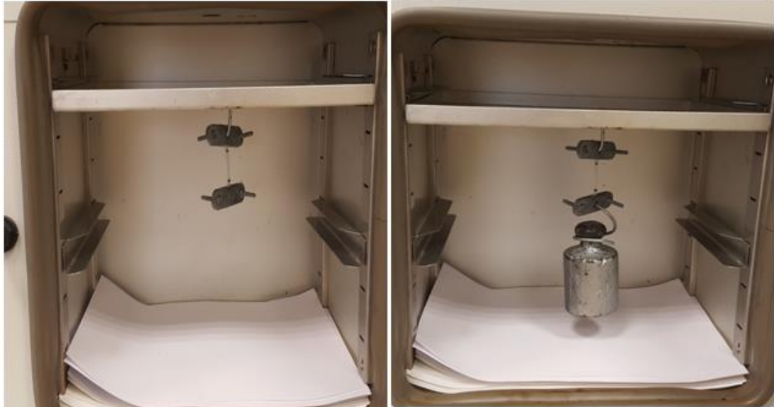
Şekil 2.7. Şekil hafıza testi için ısıtıp deforme etme
