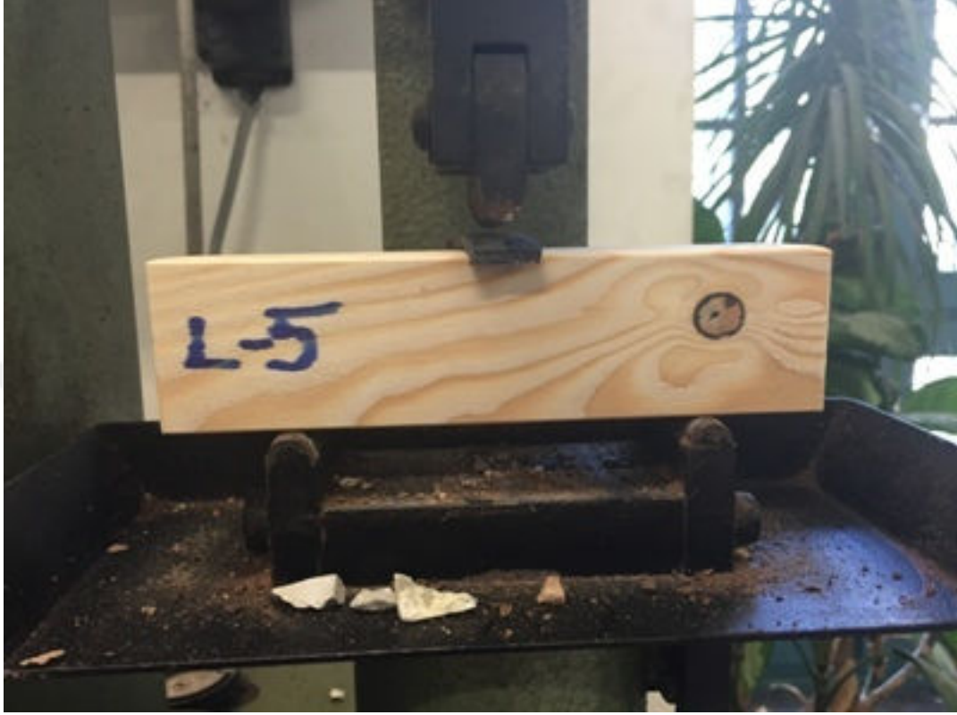
Şekil 3.53: Özgül ağırlığı yüksek olan L-5 kodlu numune.
