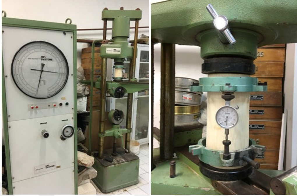
Şekil 3.33: Elastisite modülü tayini için yük altında şekil değiştirme okumaları.
