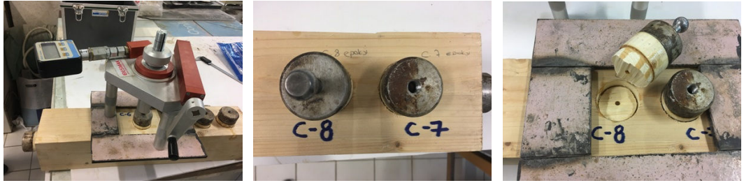
Şekil 3.145: Aderans deney düzeneği, numune örnekleri ve deney sonrası kopma anı.
