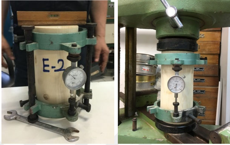
Şekil 3.89: Numunelerin yük altında şekil değiştirme okumaları.
