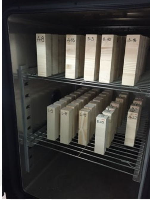
Şekil 3.26: Klima dolabının içine yerleştirilen numuneler.
