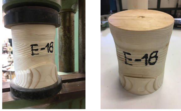
Şekil 3.121: Lifleri yük yönüne dik dört lamelli E-18 kodlu numuneye basınç dayanım testi uygulaması.
