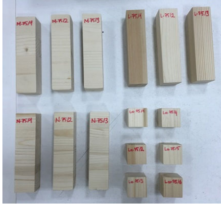
Şekil 3.122: Malzemede sıcaklık dayanım ilişkisini incelemek için kodlanan ve 75C°'ye konulan numuneler.
