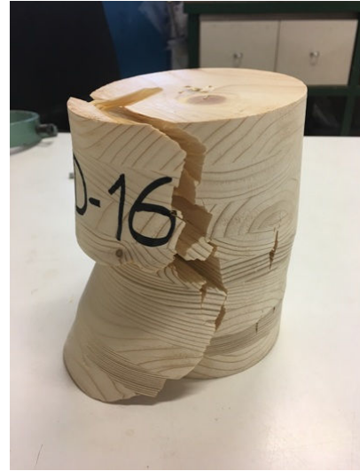
Şekil 3.120: Lifleri yük yönüne ters dokuz lamelli D-16 kodlu numuneye basınç dayanım testi uygulaması.
