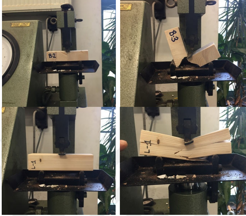
Şekil 3.28: 4 lamelli B kodlu ve masif ladin L kodlu numunelerin eğilme dayanımı testi uygulaması.
