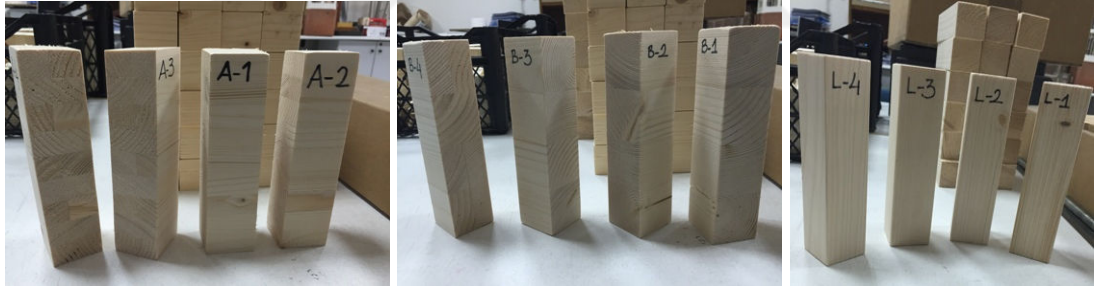
Şekil 3.2: Islanma-kuruma deneylerinde kullanılan A, B ve L kodlu numuneler.
