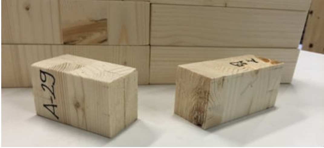
Şekil 3.57: Yük ekseninde budak olan A-29 kodlu numune.
