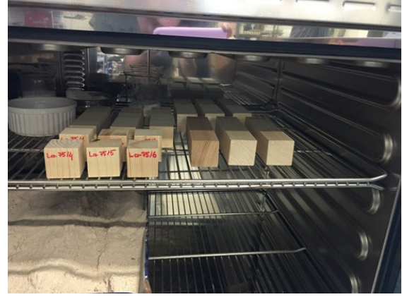
Şekil 3.122: Malzemede sıcaklık dayanım ilişkisini incelemek için kodlanan ve 75C°'ye konulan numuneler.
