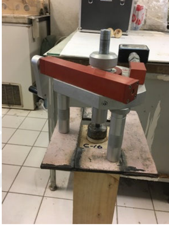
Şekil 3.43: Besmak marka aderans deneyi cihazı ve deney uygulaması.
