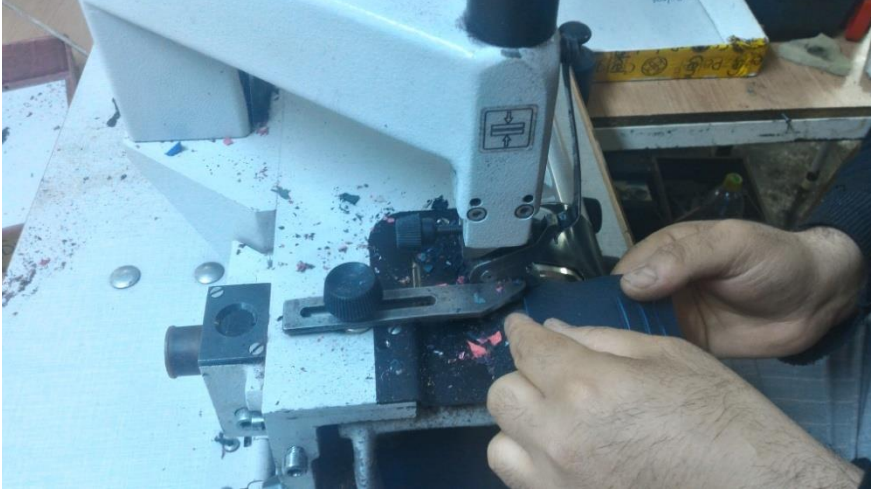
Resim 2.54. Kenar tıraşlama, (Cengiz Pakel' in atölyesinde 07 Haziran 2016'da çekilmiştir)
