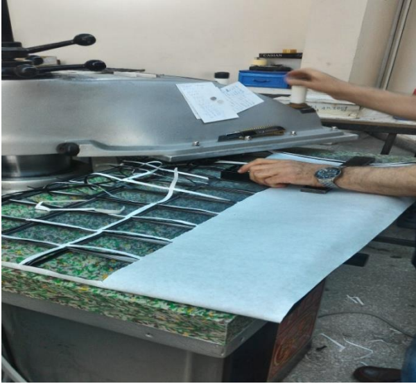
Resim 2.51. Derilerin kesilmesi, (Cengiz Pakel' in atölyesinde 07 Haziran 2016'da çekilmiştir)
