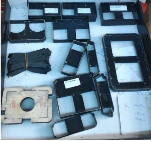
Resim 2.50. Çelik cüzdan kalıpları, (Cengiz Pakel' in atölyesinde 07 Haziran 2016'da çekilmiştir)
