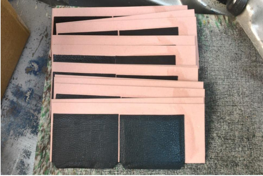
Resim 2.57. Cüzdan bölümlerini kartonlama (Cengiz Pakel' in atölyesinde 07 Haziran 2016'da çekilmiştir)
