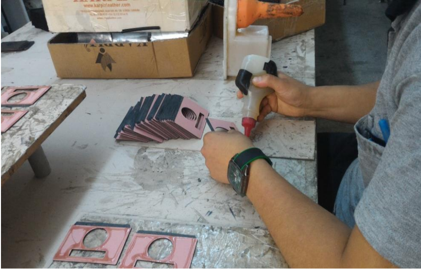
Resim 2.59. Araçlanan kartlıklara yapıştırıcı sürülmesi, (Cengiz Pakel' in atölyesinde 07 Haziran 2016'da çekilmiştir)
