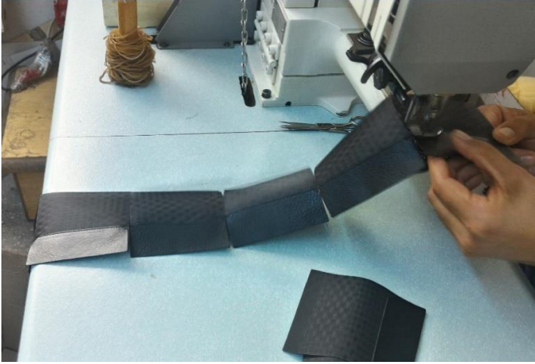
Resim 2.61. Kıvrılan derilerin astarlanıp dikilmesi, (Cengiz Pakel' in atölyesinde 07 Haziran 2016'da çekilmiştir)
