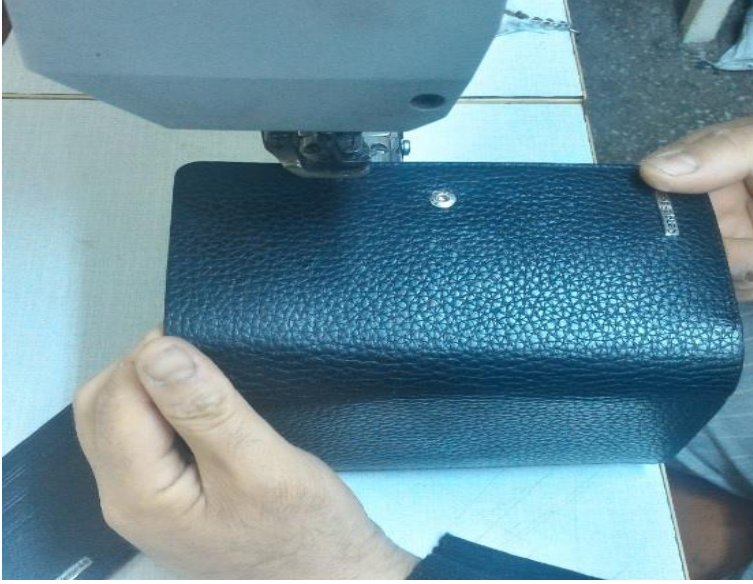
Resim 2.65. Cüzdanın dikilmesi, (Cengiz Pakel' in atölyesinde 07 Haziran 2016'da çekilmiştir)
