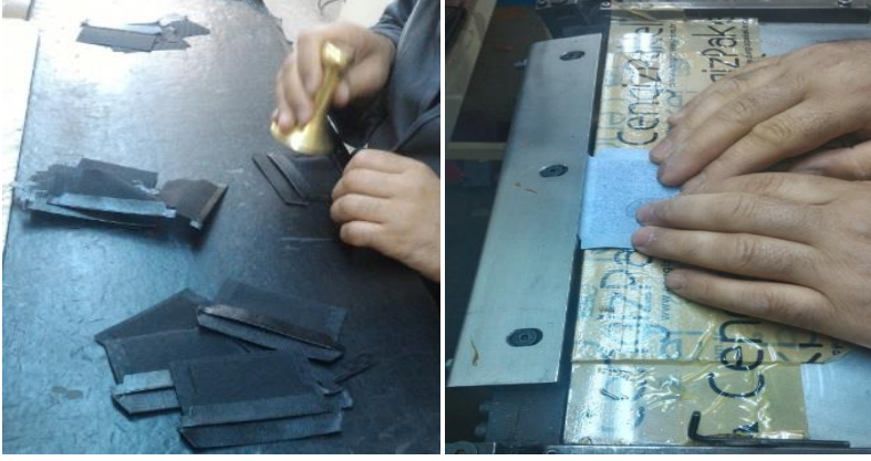
Resim 2.56. Muşta ve Kıvrırma Makinesiyle Kenar Kıvrırma, (Cengiz Pakel' in atölyesinde 07 Haziran 2016'da çekilmiştir)
