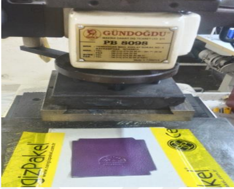
Resim 2.62. Firmanın ambleminin basılması, (Cengiz Pakel' in atölyesinde 07 Haziran 2016'da çekilmiştir)
