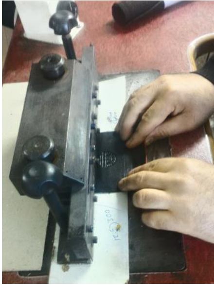
Resim 2.63. Kenar çizgisi yapma, (Cengiz Pakel' in atölyesinde 07 Haziran 2016'da çekilmiştir)
