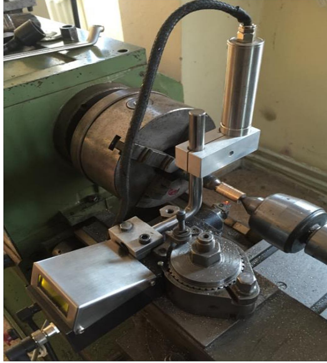
Şekil 3.50 Dinamometre ve sıcaklık ölçerin bağlantısı
