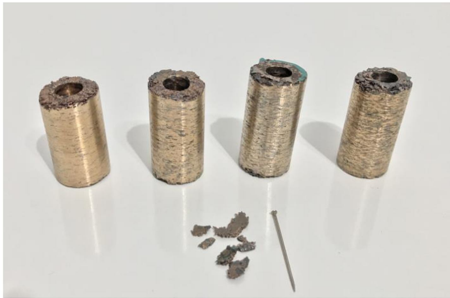
Şekil 4.12 Serbest kenar etkisi sonucu yüzeylerde oluşan kopmalar sonucu oluşan talaşlar
