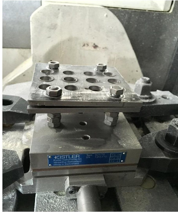
Şekil 3.391 Kistler 9257B model dinamometre
