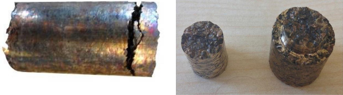
Şekil 3.29 Etkili bir birleşimin meydana gelmediği ön deneme numuneleri
