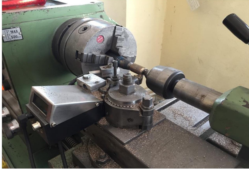
Şekil 3.49 Dinamometre ve sensörlerin tezgâha bağlantısı
