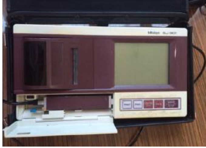
Şekil 3.43 Mitutoyo SJ-301 yüzey pürüzlülük ölçme cihazı
