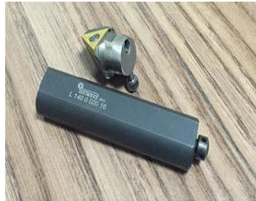
Şekil 3.47 Takım tutucu montajında kullanılan bağlama aparatı ve kartuşun son hali (Kuntoğlu, 2016)
