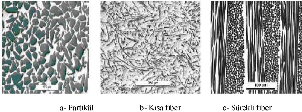
Şekil 3.3 Takviye fazı geometrisine göre MMK malzemeler (Aslan, 2014)
