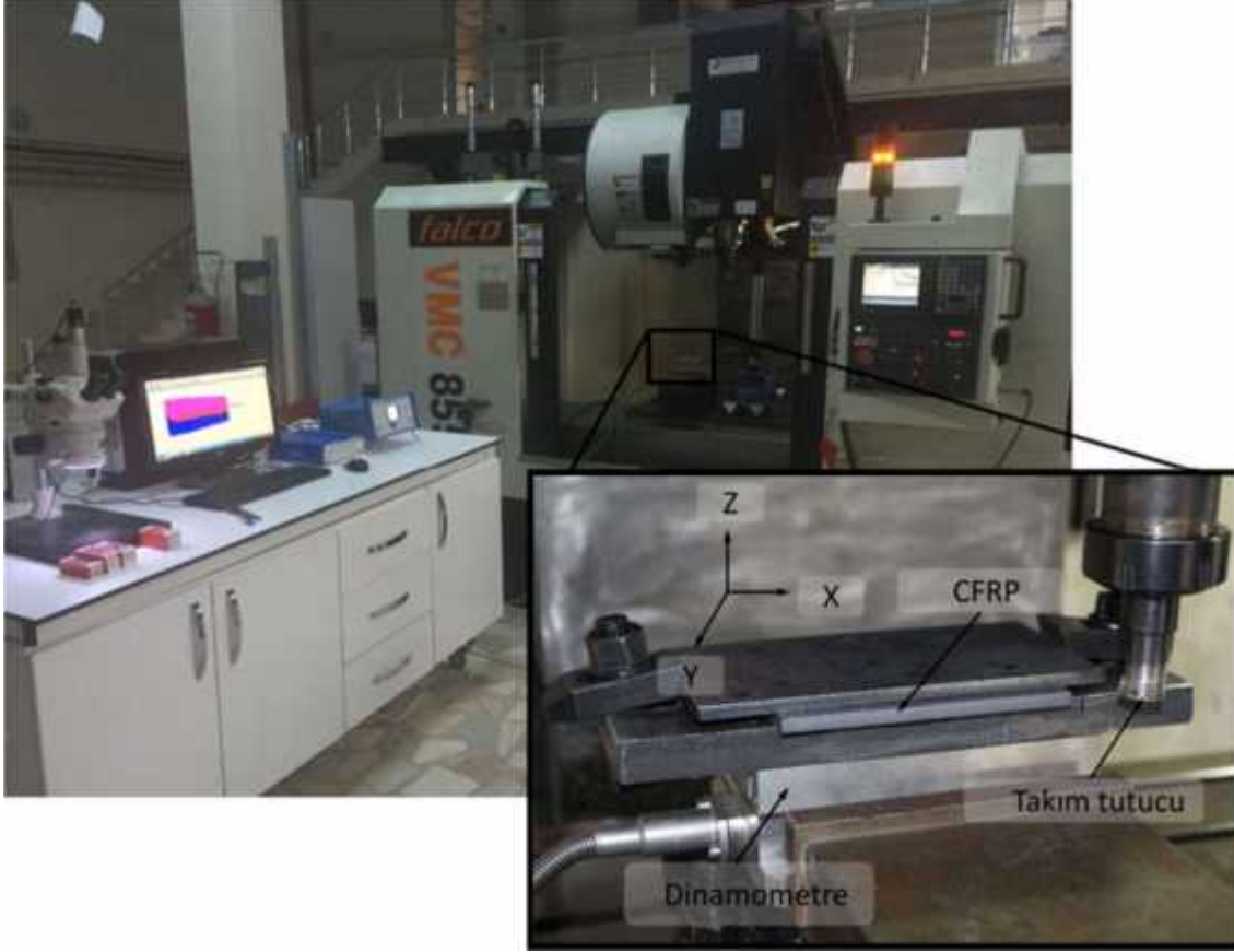
Şekil 26: Deneylerde kullanılan CNC dik işleme merkezi ve deney düzeneğinin genel görüntüsü.
