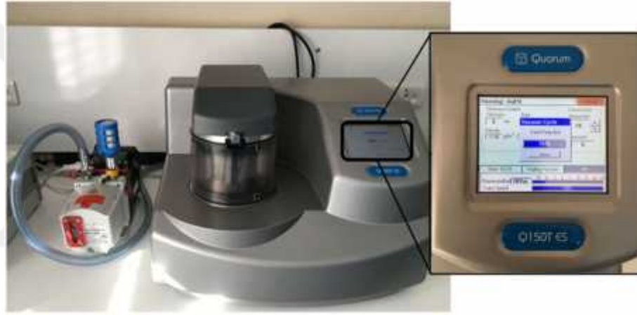
Şekil 31: Au/Pd kaplamasında kullanılan Q150T-ES modelindeki kaplama cihazının görünümü.
