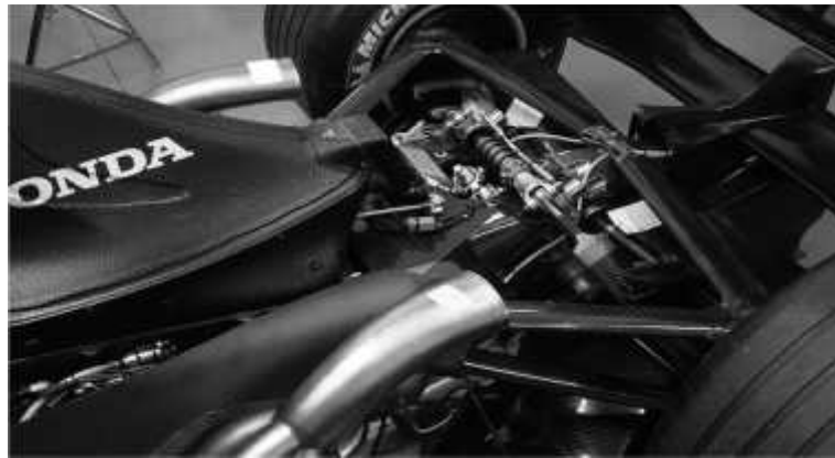
Şekil 9: Formula 1 yarış arabasındaki karbon fiber takviyeli süspansiyon ve vites kutusu görünümü (Mallick, 2008).
