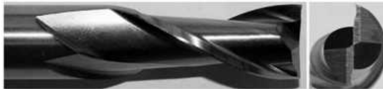
Şekil 19: Karbür helisel freze takımı görünümü (Kalla vd., 2010).
