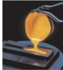
Radyoaktif atıkların, çevreye yayılmasını önlemek için platin potada cam ile eritilerek kanştırılıp çelik kalıplara dökülmesi
