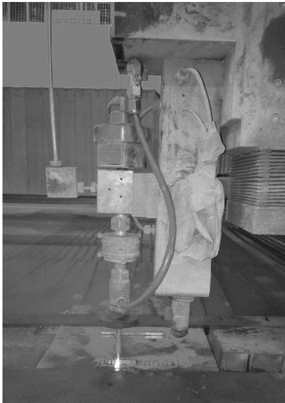
Resim 7.1. ASJİ ile Ti6Al4V çubuklarının kesimi sırasında çekilmiş bir fotoğraf
