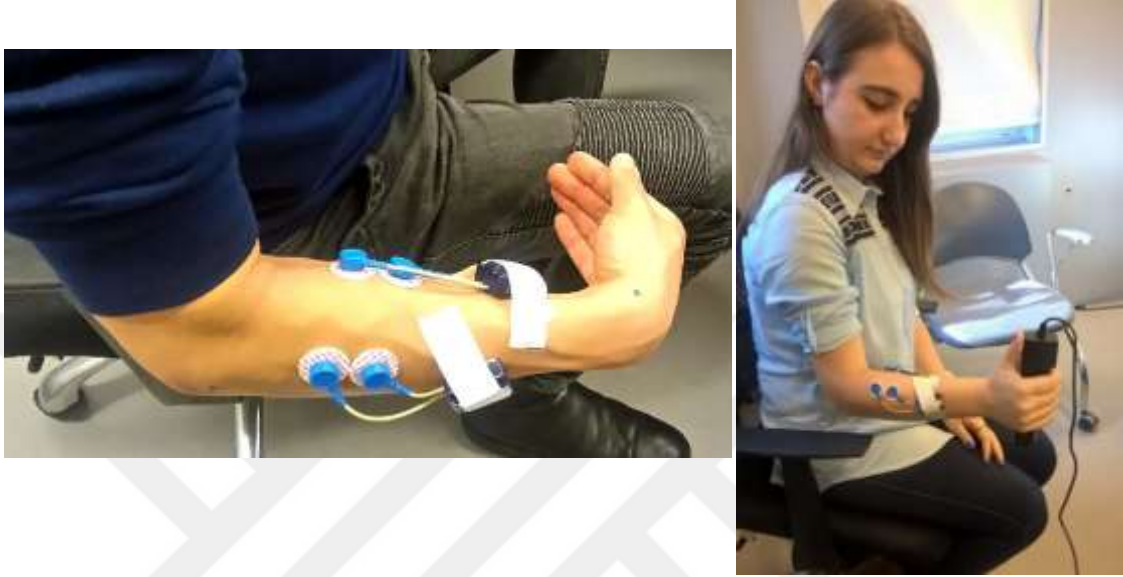
Şekil 3.6: Protokol 1 için (sol) ve Protokol 2 için (sağ) EMG sinyali ölçüm düzeneği.
