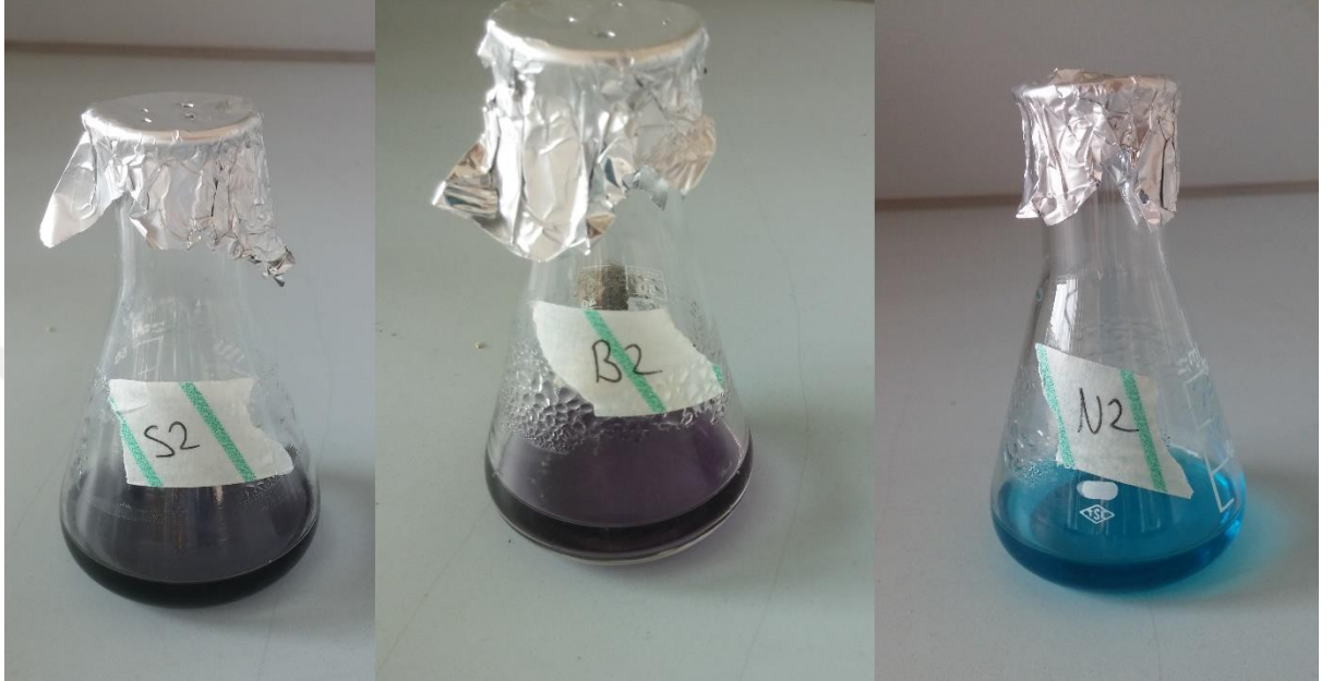
Şekil 3.4: 10 mL hacimde gerçekleştirilen, rekombinant lakkaz PsLcc2 ve ABTS varlığında Malaşit Yeşili üzerinde boya giderim analizleri ve 24.saat sonundaki örneklerin görüntüsü.
