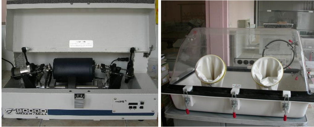
Şekil 2.2 : (a) Yüksek enerjili öğütme sistemi, (b) kapalı ortam kutusu.
