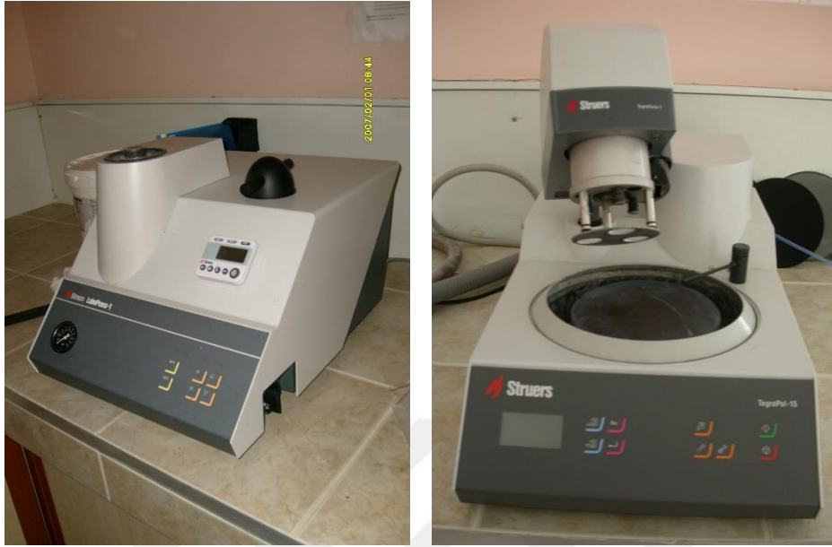
Şekil 2.11 : (a) bakalite alma sistemi, (b) numune parlatma sistemi.
