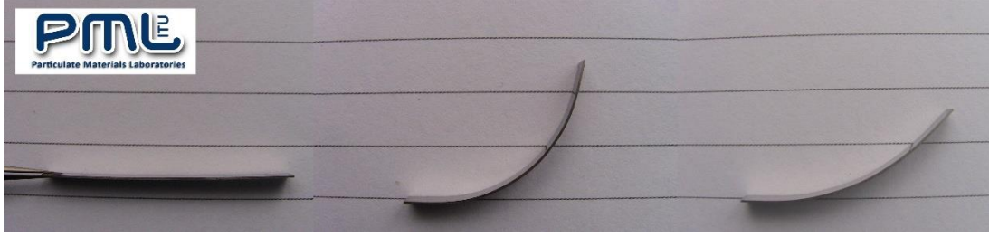
Şekil 3.55 : (a) Sinterlenmiş, (b) deformasyon sonrası ve (c) ısıtıl işlem sonrası Fe14Mn6Si9Cr5Ni-4MA numunesinin makro görüntüleri.
