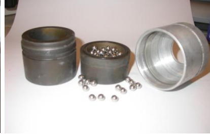
Şekil 1.21 : Mekanik alaşımlama için kullanılan yüksek enerjili öğütme sistemi.
