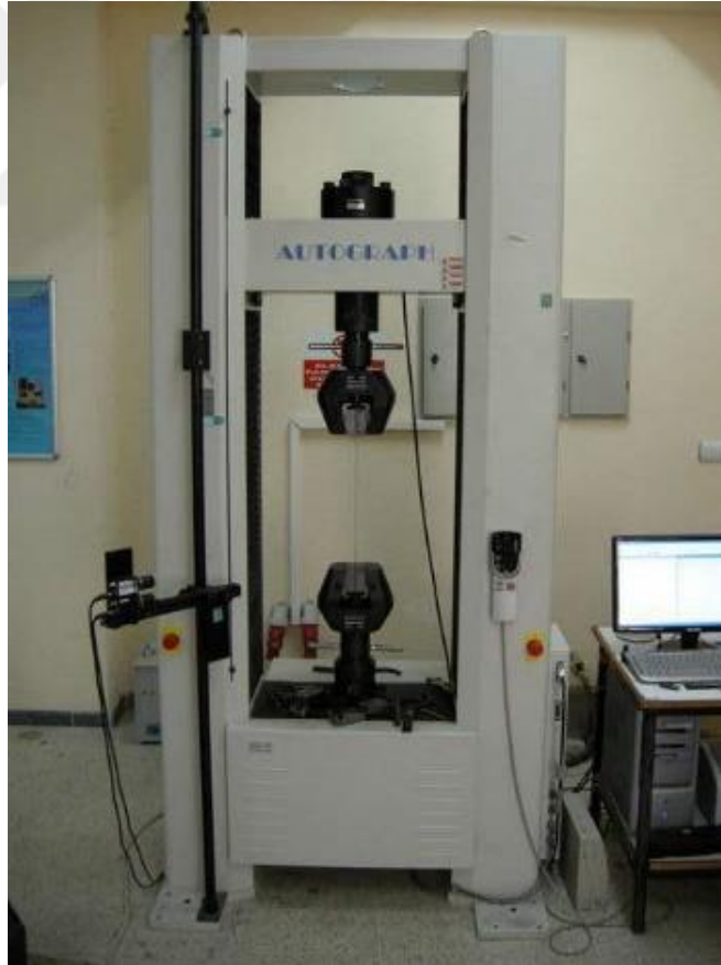
Şekil 2.16 : Numunelerin deformasyonu amacıyla kullanılan basma test cihazı.
