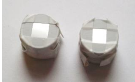
Şekil 3.78 : MA’lanmış Fe15Mn6Si5Cr3Ni ve harmanlanmış tozlardan elde edilen Fe15Mn6Si5Cr3Ni numunelerinin tuz sisi testi öncesi maskelenen yüzey makro görüntüleri.
