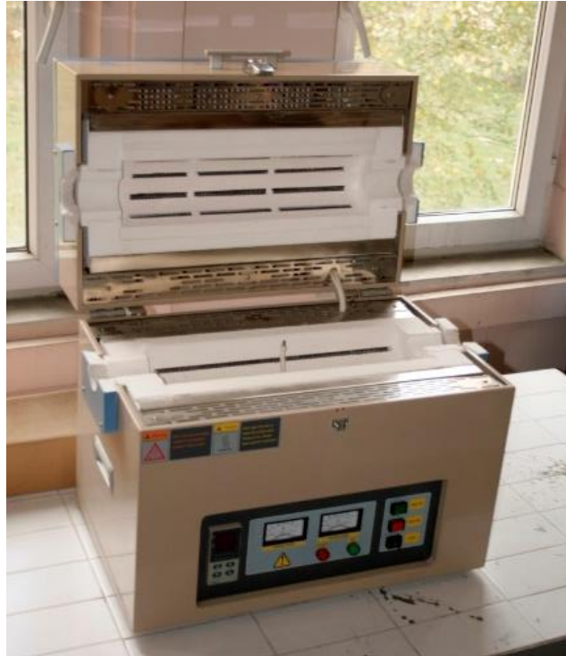
Şekil 2.15 : Şekil bellek etkisinin incelenmesi amacıyla kullanılan ısıl işlem fırını.
