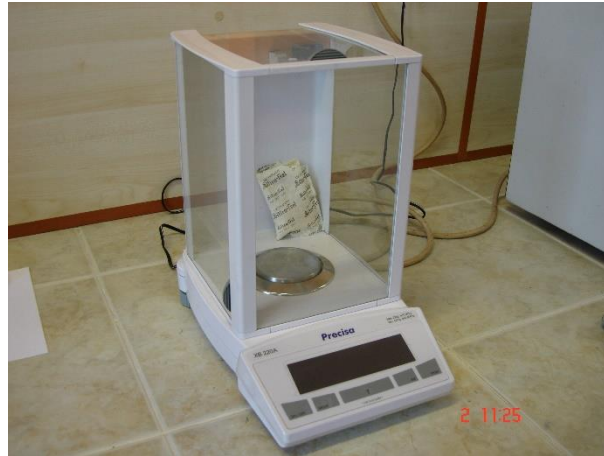
Şekil 2.12 : Arşimet kitli hassas terazi sistemi.
