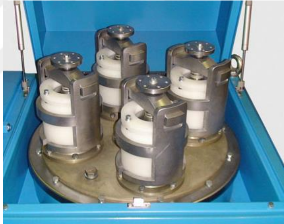
Şekil 1.22 : Mekanik alaşımlama amacıyla kullanılan gezegen tipi karıştırıcı.
