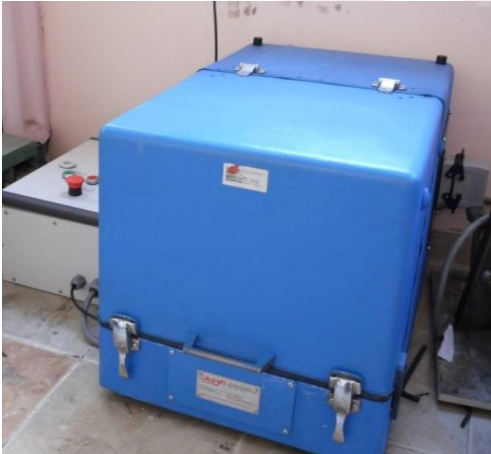
Şekil 1.22 : Mekanik alaşımlama amacıyla kullanılan gezegen tipi karıştırıcı.
