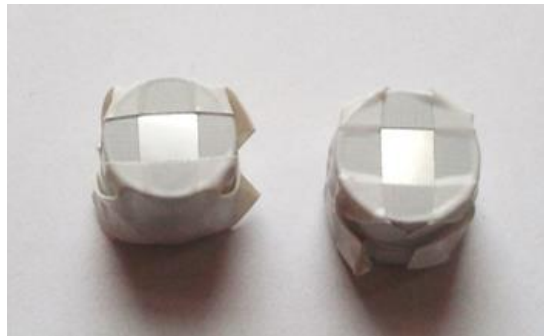
Şekil 3.70 : 4 saat MA’lanmış Fe14Mn6Si9Cr5Ni ve Fe16Mn6Si numunelerinin tuz sisi testi öncesi maskelenen yüzey makro görüntüleri.
