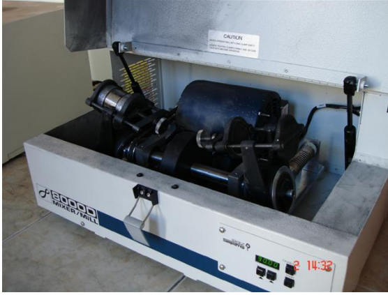
Şekil 1.21 : Mekanik alaşımlama için kullanılan yüksek enerjili öğütme sistemi.
